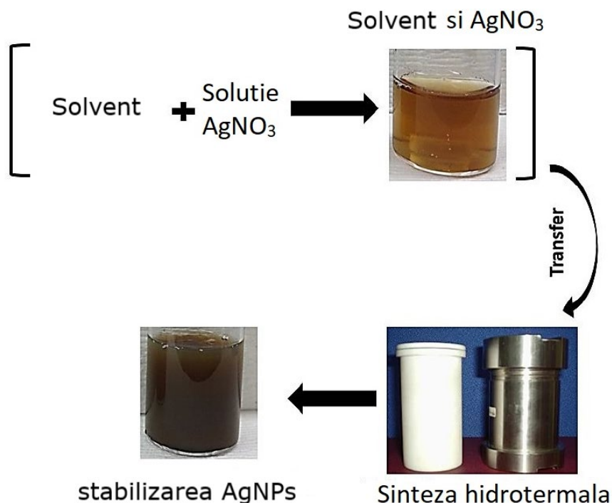
Figura 2.4. Reprezentarea schematică a sintezei prin metoda hidrotermală a AgNPs [170, 171]
