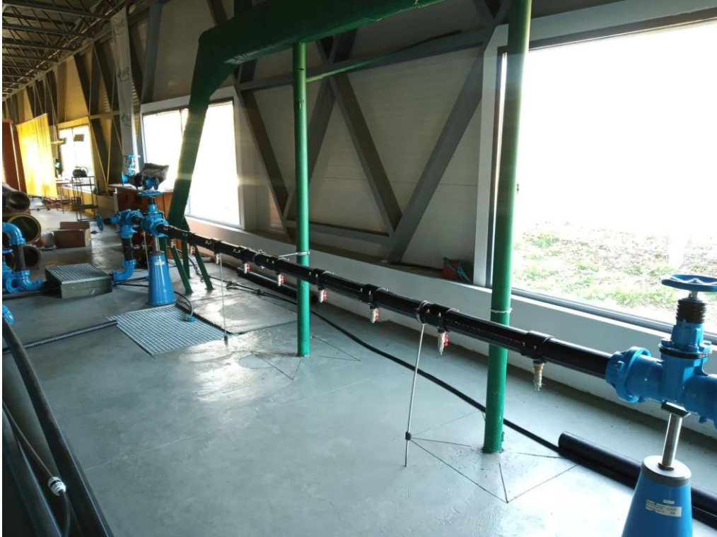
Figura 46. Tronson de calcul pentru studiul zonei pe care se produc turbulențe în aval
