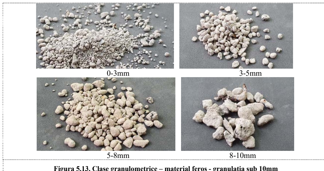
Figura 5.13. Clase granulometrice – material feros - granulația sub 10mm
