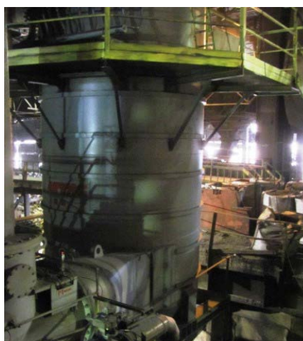
Figura 7.4. Instalația de tratament în vid tip VD
