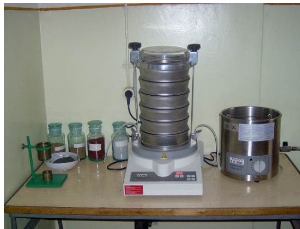
Figura 4.20. Instalația pentru clasarea șlamului feros
