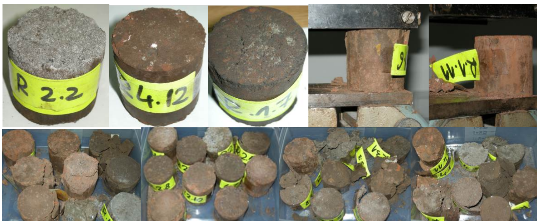
Figura 5.11. Aspecte din timpul determinării rezistenței la compresiune
