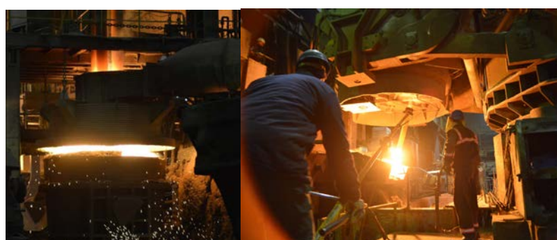
Figura 7.3. Instalația de tratament secundar LF
