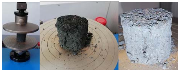
Figura 5.21. Încercările de rezistență la compresiune pentru brichetele experimentale
