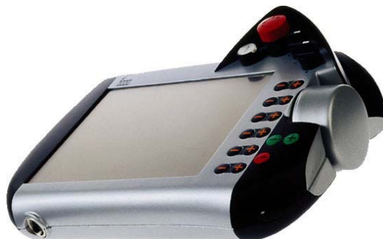
Fig. 8 - Consolă mobilă de învățare KUKA cu ecran tactil și recunoaștere vocală [28]
