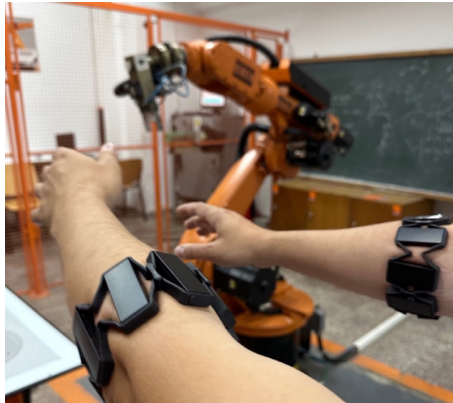
Fig. 54 - Aplicație conexiune Dual Myo – KUKA KR15
