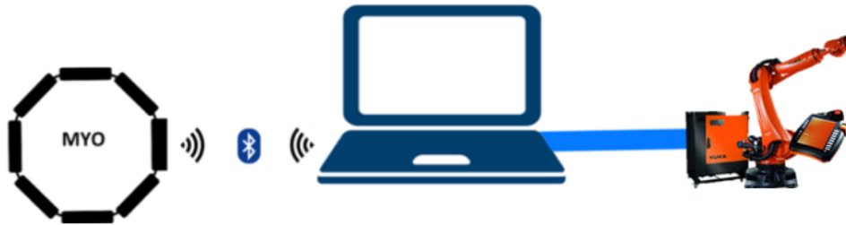
Fig. 41 - Schema de conectare Myo – KUKA KR15
