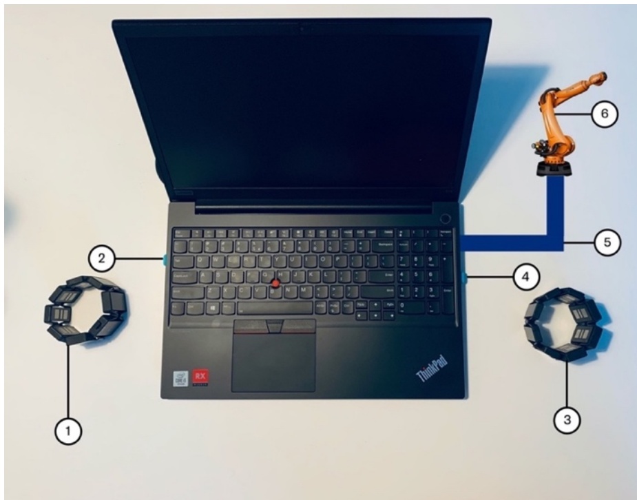
Fig. 55 - Arhitectura sistemului de conectare Dual Myo - KUKA KR15
