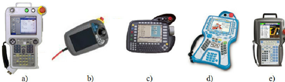
Fig. 9 - Consolă mobilă de învățare pentru roboții industriali a) MOTOMAN NX100 b). ABB IRC5 c). KUKA Robotics d). COMAU Robotics e). FANUC [29]
