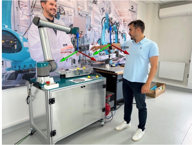
Fig. 76 - Corelare mână - robot UR10e
