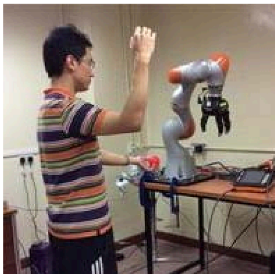
Fig. 15 - Control cu ajutorul Microsoft Kinect si KUKA LBR iiwa R820 [34]
