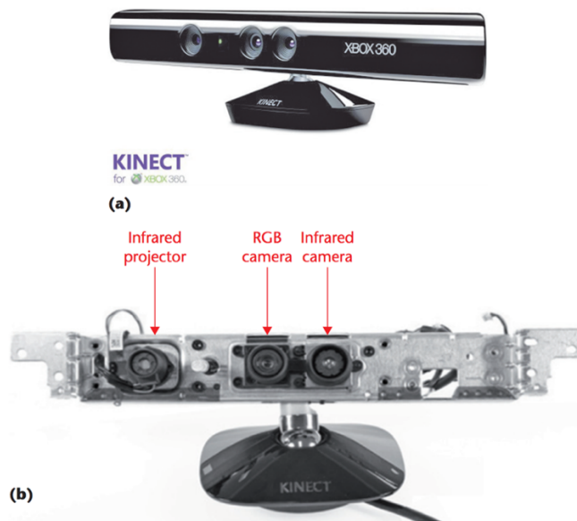
Fig. 12 - Microsoft Kinect - a). Senzor Kinect de la Xbox 360 b). proiector infraroșu, cameră infraroșu și cameră RGB în interiorul senzorului Kinect [31]
