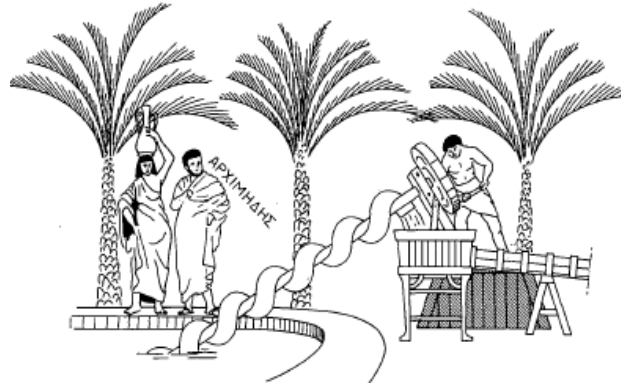
Figura 1.2. Desecarea cu ajutorul șurubului lui Arhimede (î.e.n.)
