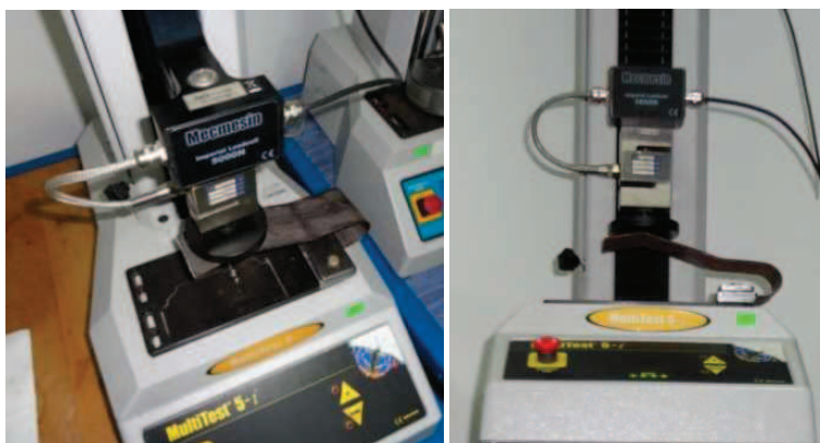
Fig.6.58. Standul experimental utilizat pentru studiul arcurilor lamelare
