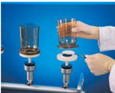
Figura II.8. Sistem de filtrare pe membrană
