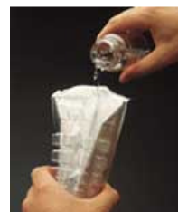
Figura II.10. Adăugare probă în plicul Quanty Tray
