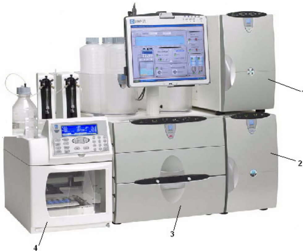
Figura II.6. Sistem IC - DIONEX - 3000
