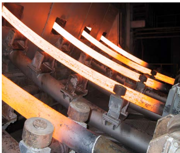
Fig. 2.11. Ieșirea semifabricatului TC din zona de răcire secundară. [53]
