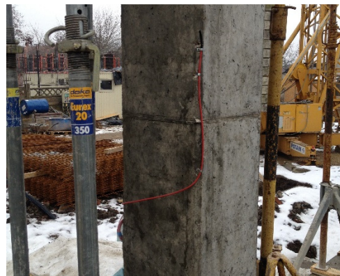
Figura 5.13 - Senzori pereți exteriori – colț intrând 1: detaliu și implementare
