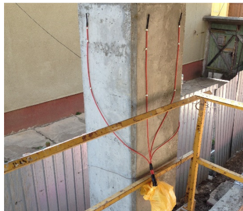
Figura 5.19 - Senzori pereți exteriori – colț ieșind spațiu neîncălzit 3: detaliu și implementare
