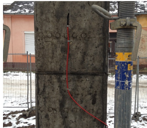
Figura 5.15 - Senzori pereți exteriori – stâlp intermediar 1: detaliu și implementare
