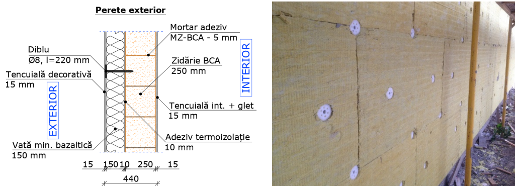
Figura 3.6 - Perete exterior: detaliu și implementare
