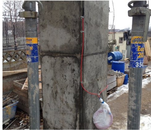
Figura 5.11 - Senzori pereți exteriori – colț ieșind 1: detaliu și implementare
