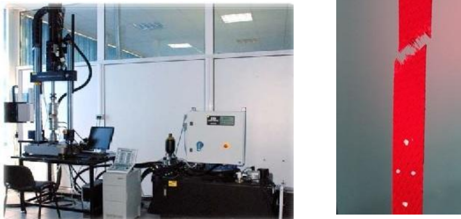
Fig.5.5. Efectuarea testelor de tracțiune monoaxială (mașina pentru încercări statice și dinamice Instron 8874)
