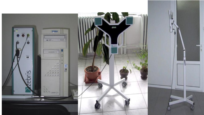
Fig.3.4 Unitatea centrală și emițătorul de ultrasunete [131]
