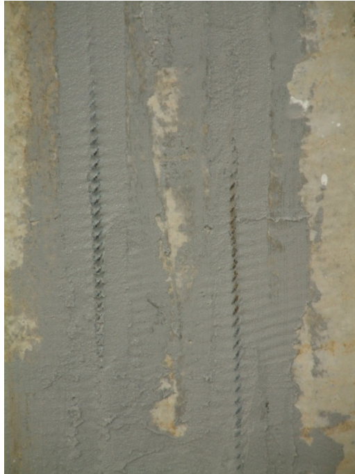
Figura 4.75. Detaliu umplere șlițuri laterale pentru elementul C3C-BM-AF
