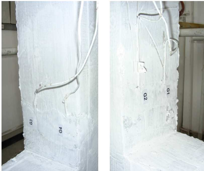
Figura 4.23. Detaliu dispunere timbre tensometrice G1 , G2, G3 și G4 pentru elementul C1C
