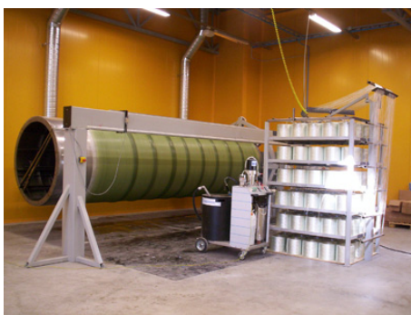
Figura 2.2. Înfășurarea continuă cu filamente de fibră [5]
