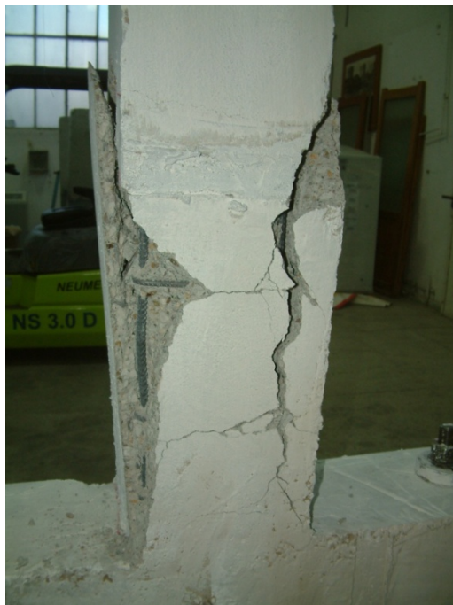
Figura 4.78. Cedarea elementului C3M-BM-AF
