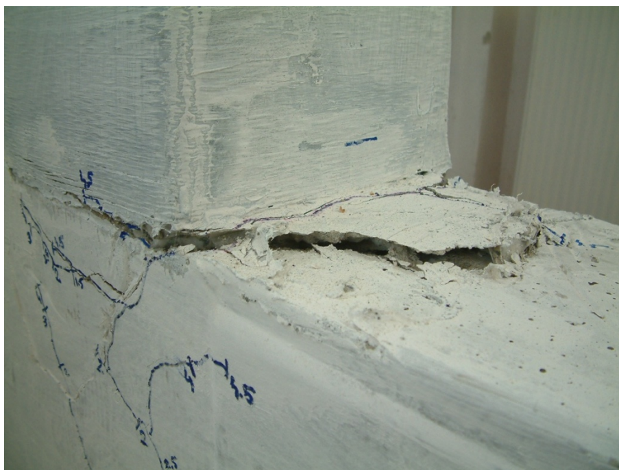
Figura 4.104. Cedarea prin smulgerea ancorajului chimic al barelor laterale pentru elementul C3M-BM+GW (55kN)
