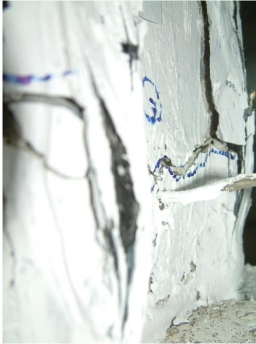
Figura 4.96. Ruperea fibrei de carbon întinse pentru elementul C8C2-CSS-AF
