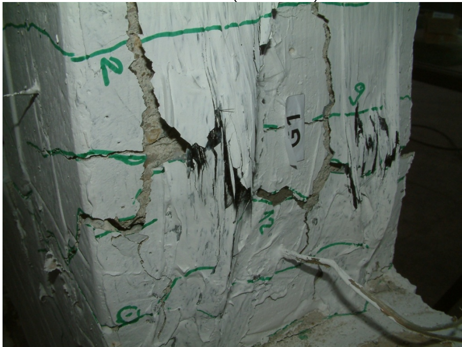
Figura 4.88. Ruperea fibrei de carbon în întindere pentru elementul C8C1-CSS-AF(D1 = 36mm)
