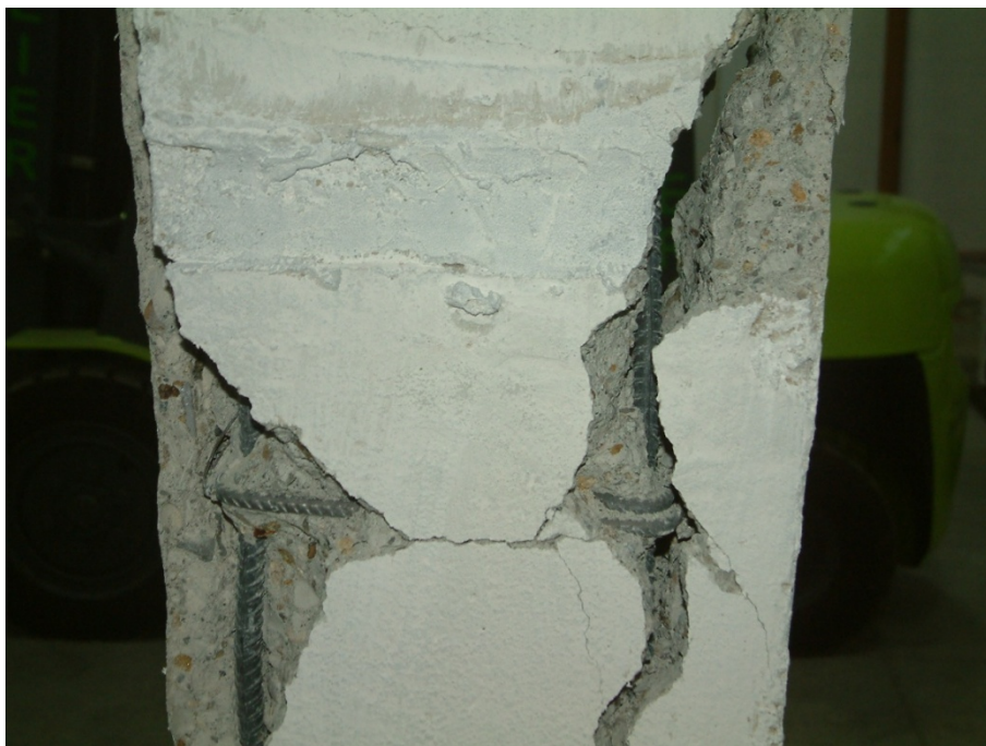
Figura 4.79. Detaliu cedare pentru elementul C3M-BM-AF ( D1 = 24\text{mm} )
