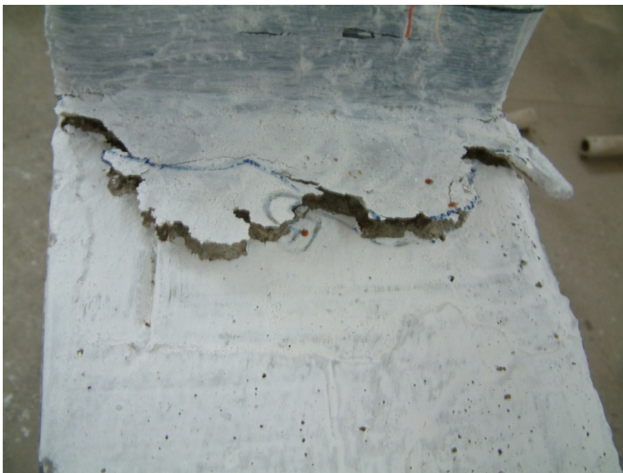
Figura 4.112. Detaliu cedare pentru elementul C4M-BM+CW (50kN)
