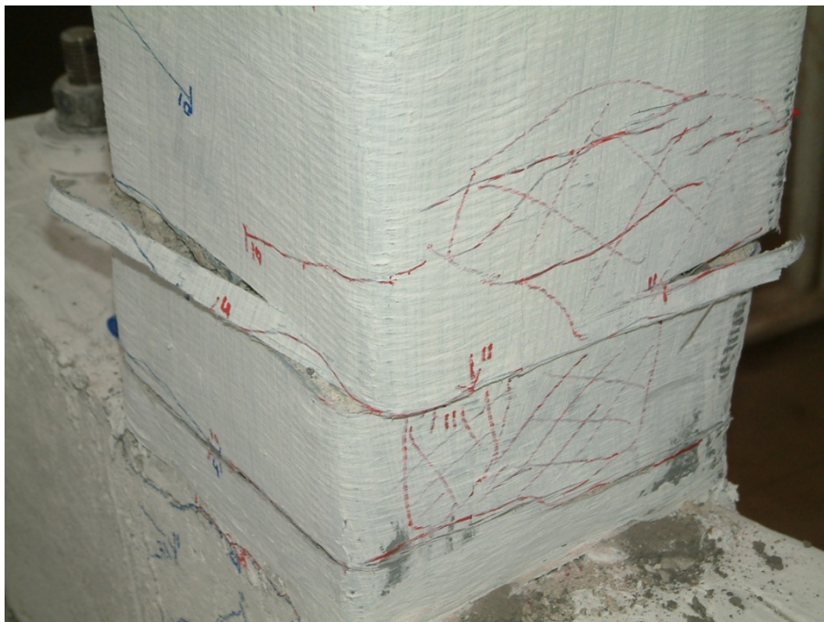
Figura 4.129. Ruperea fibrei de înfășurare pentru elementul C7C1-BM+GW
