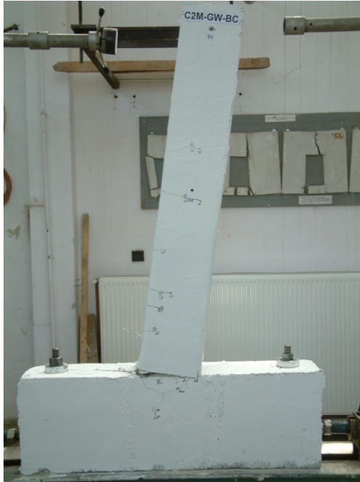
Figura 4.49. Cedarea elementului C2M-GW-BC
