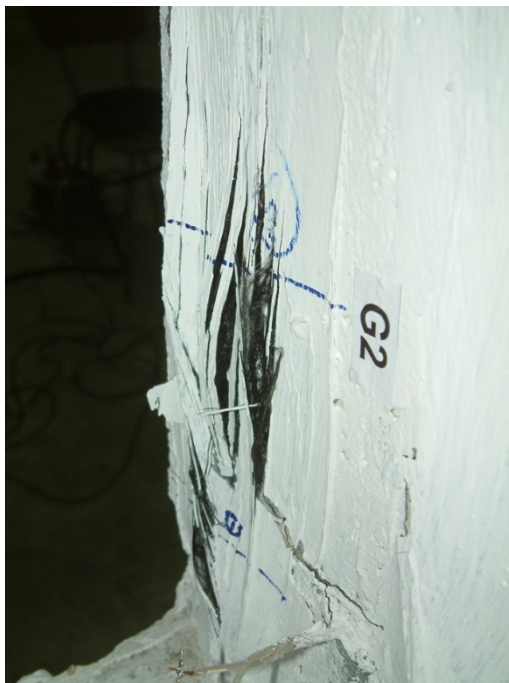
Figura 4.97. Ruperea fibrei de carbon în întindere pentru elementul C8C2-CSS-AF
