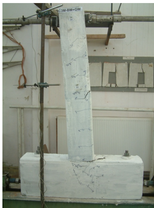
Figura 4.103. Starea la cedare a elementului C3M-BM+GW
