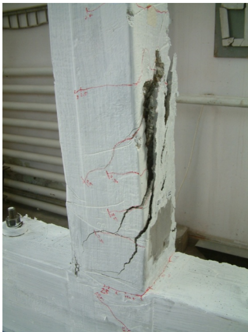
Figura 4.70. Cedarea elementului C3M-BM-AF (38kN)
