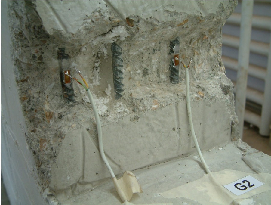
Figura 4.15. Detaliu dispunere timbre tensometrice G1 și G2 pentru elementul C1M
