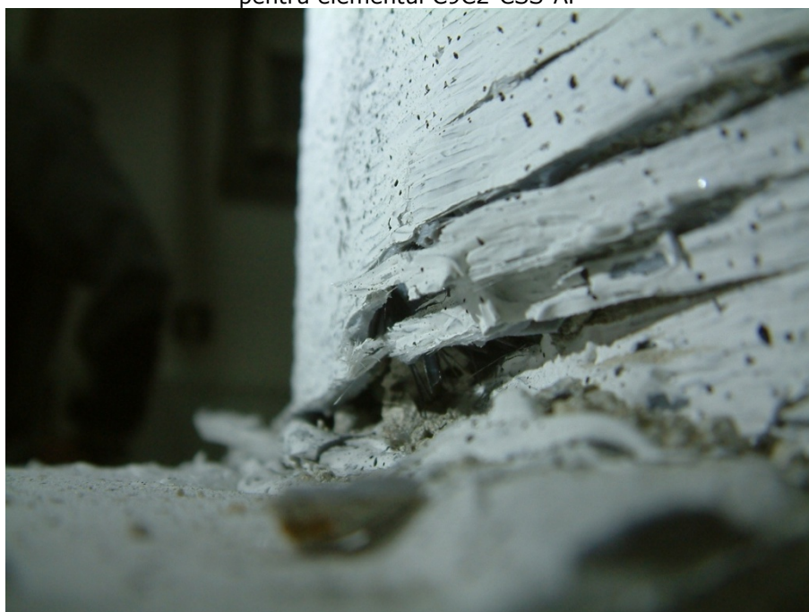
Figura 4.153. Inițiere cedare consolidare înfășurare pentru elementul C9C2-CSS-AF
