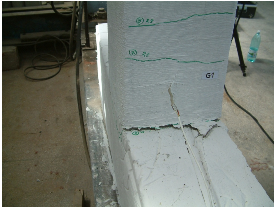
Figura 4.47.- Timbrul tensometric G1 pentru elementul C2M-GW-BC
