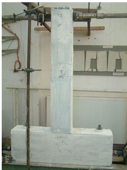
Figura 4.101. Vedere generală a standului experimental pentru elementul C3M-BM+GW
