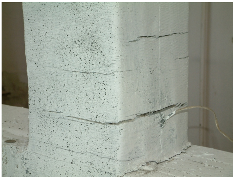
Figura 4.136. Rupere țesătură pe direcția perpendiculară pe direcția fibrelor pentru elementul C7C2-BM+GW
