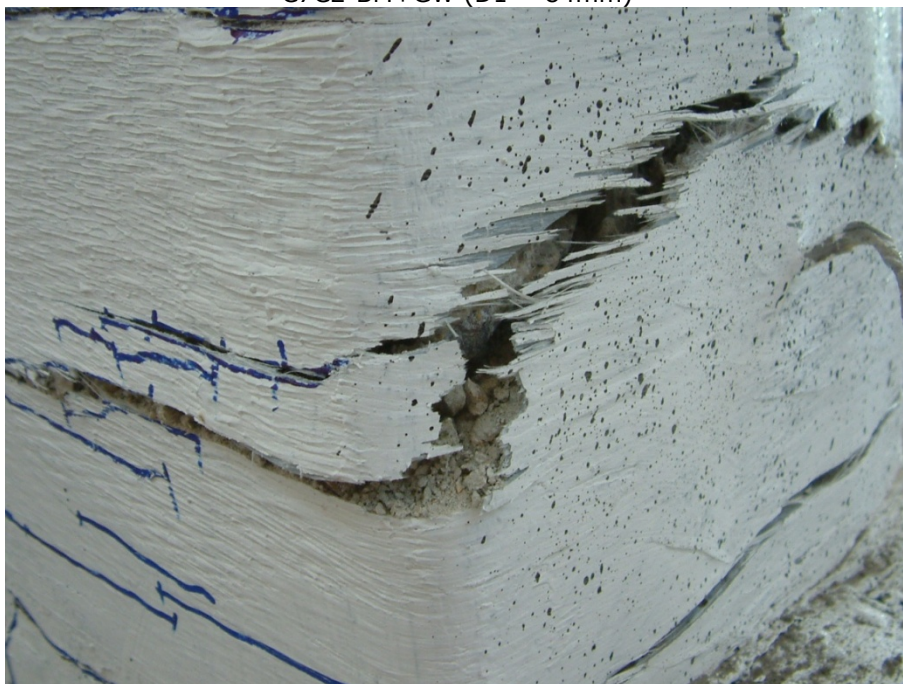
Figura 4.139. Ruperea fibrei de înfășurare pentru elementul C7C2-BM+GW (D1 = 84mm)
