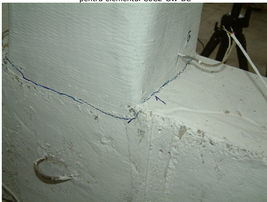
Figura 4.62. Inițierea formării articulației de alunecare la baza elementului pentru elementul C6C2-GW-BC
