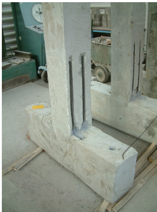
Figura 4.74. Detaliu amplasare bare laterale pentru elementul C3C-BM-AF
