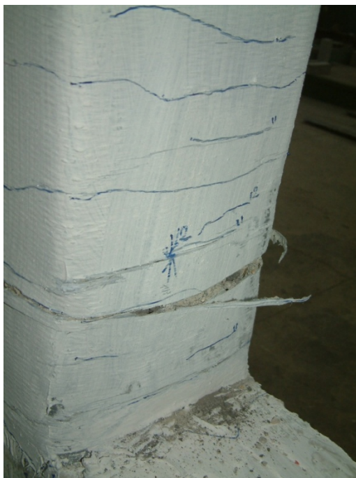
Figura 4.130. Ruperea fibrei de înfășurare pentru elementul C7C1-BM+GW
