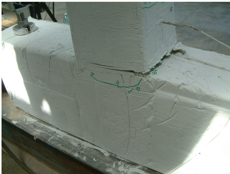
Figura 4.48. Inițierea cedării elementului C2M-GW-BC
