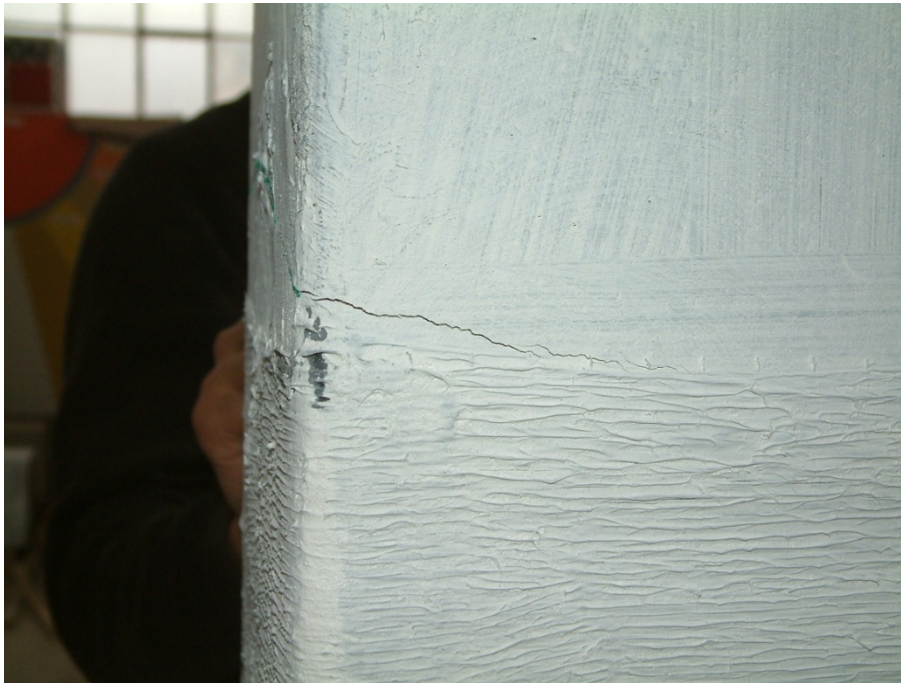
Figura 4.118. Apariția fisurilor la partea superioară a înfășurării pentru elementul C4C-BM+CW
