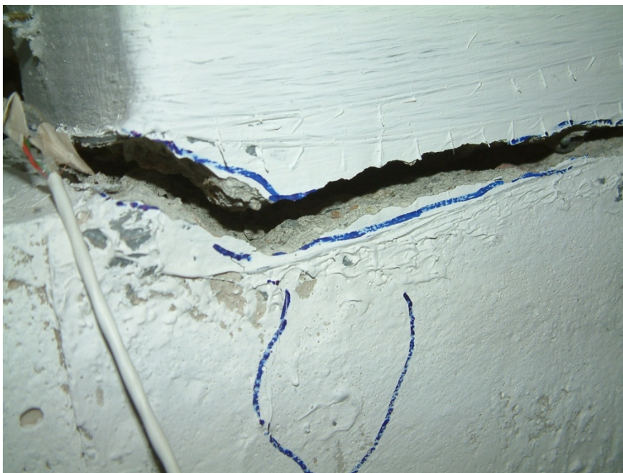
Figura 4.63. Formarea articulației de alunecare la bază și cedare armătură interioară pentru elementul C6C2-GW-BC ( D1 = 60\text{mm} )
