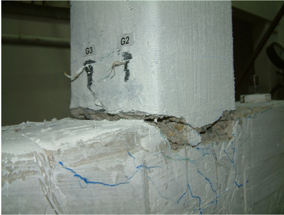
Figura 4.120. Formarea articulației la baza elementului C4C-BM+CW
