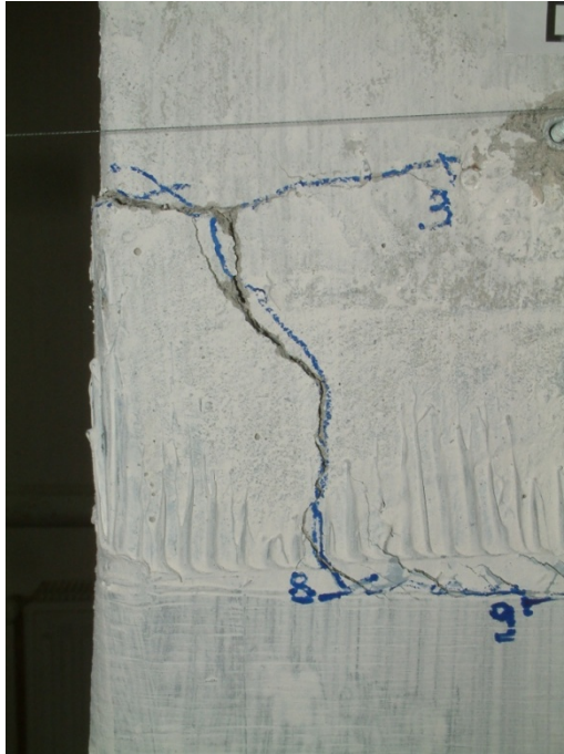
Figura 4.126. Inițiere cedare secțiune la partea superioară a consolidării pentru elementul C7C1-BM+GW ( D1 = 18\text{mm} )
