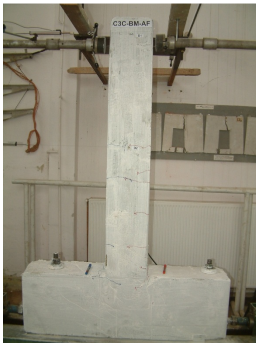
Figura 4.76. Vedere generală a standului experimental pentru elementul C3C-BM-AF
