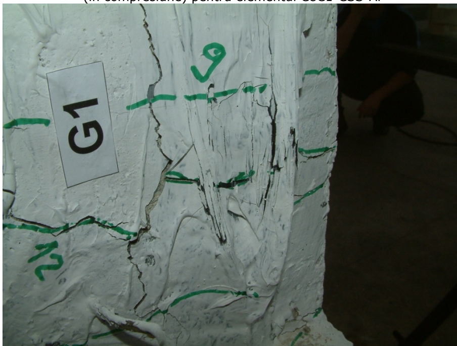
Figura 4.86. Fază inițială cedare consolidare laterală (în întindere) pentru elementul C8C1-CSS-AF (D1 = 36mm)
