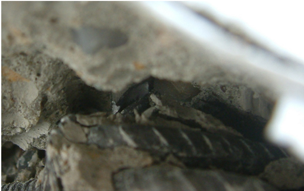
Figura 4.50. Armătura întinsă ruptă la cedarea elementului C2M-GW-BC
