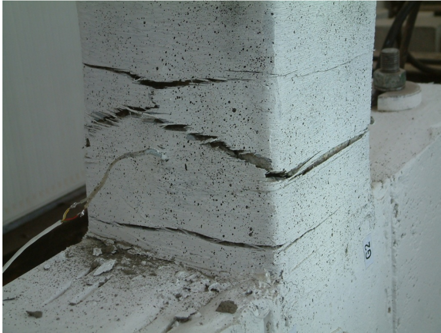
Figura 4.138. Ruperea fibrei de înfășurare pentru elementul C7C2-BM+GW (D1 = 84mm)
