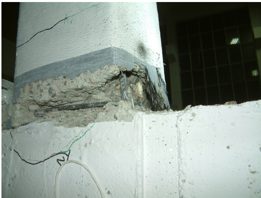
Figura 4.156. Starea la cedare a elementului C9C2-CSS-AF
