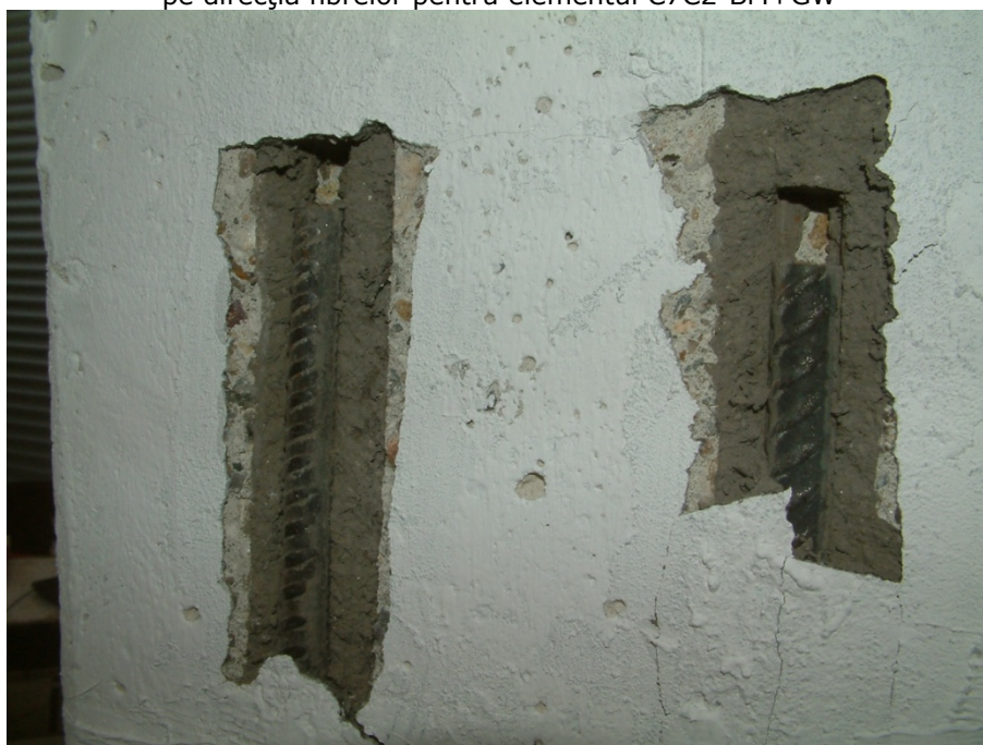
Figura 4.137. Alunecare sistem de consolidare laterală pentru elementul C7C2-BM+GW ( D_1 = 72\text{mm} )
