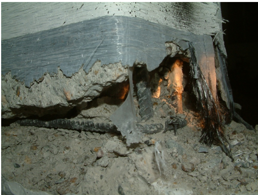
Figura 4.155. Cedare consolidare laterală întinsă pentru elementul C9C2-CSS-AF (D1 = 72mm)
