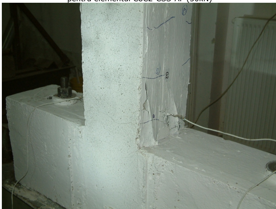
Figura 4.95. Fază inițială cedare consolidare laterală (în întindere) pentru elementul C8C2-CSS-AF
