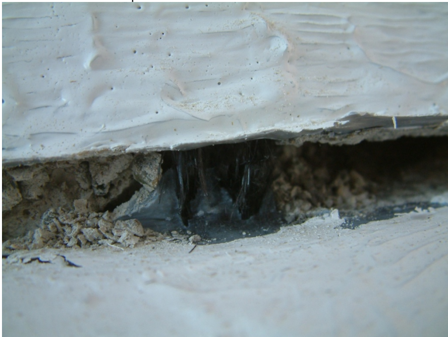
Figura 4.147. Ruperea fibrei de carbon întinse pentru elementul C9C1-CSS-AF ( D_1 = 72\text{mm} )
