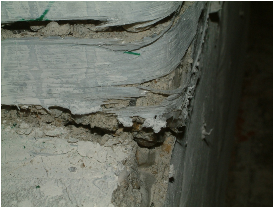
Figura 4.57. Ruperea fibrei de înfășurare pentru elementul C6C1-GW-BC ( D1 = 72\text{mm} )
