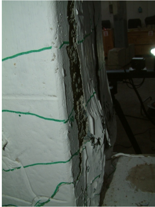
Figura 4.87. Ruperea fibrei de carbon comprimate pentru elementul C8C1-CSS-AF(D1 = 36mm)
