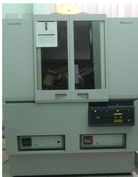
Figura 5.1. Difractometru de raze X PANalytical X'Pert PRO
