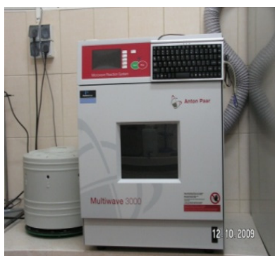
Figura 4.3. Cuptorul cu microunde (a) și autoclavele (b) utilizate în sinteza \text{TiO}_2 prin MHMW
