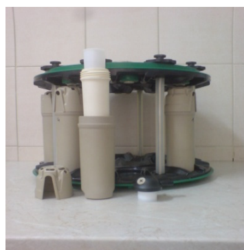
Figura 4.3. Cuptorul cu microunde (a) și autoclavele (b) utilizate în sinteza \text{TiO}_2 prin MHMW
