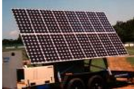
Fig. 2.8. Sistem hibrid autonom cu panouri fotovoltaice (Foto: DIERET Course)
