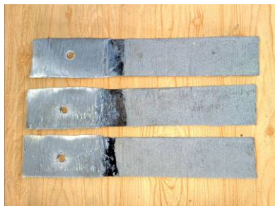
Lamele consolidate cu țesătură GFRP prin înfășurare dublu strat
