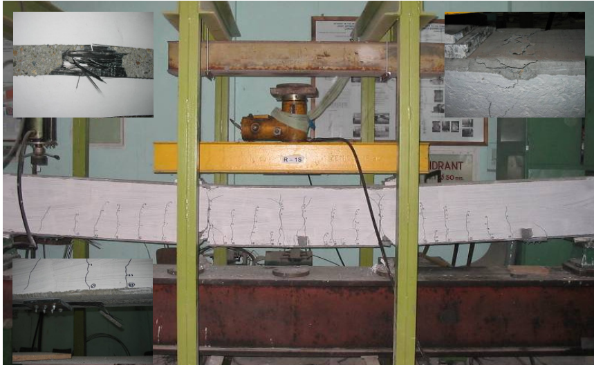
Figura 6.39. Grinda R-1S după încercare. Modurile de cedare
