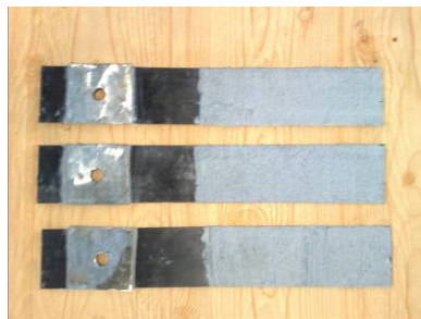
Lamele consolidate cu plăcuțe din tablă pe ambele fețe
