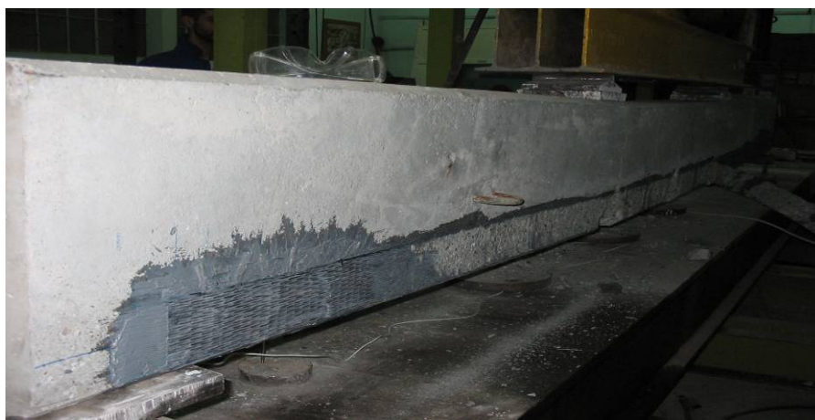
Figura 6.23. Grinda RL-2W-A - modul de cedare
