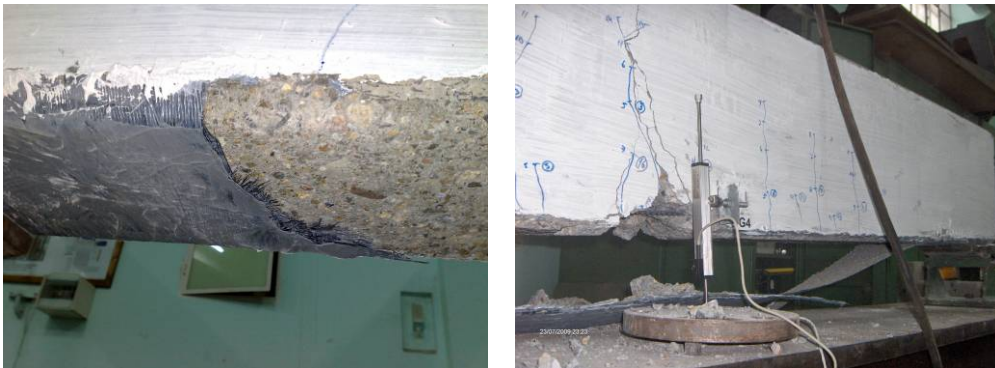
Figura 6.14. Grinda R-2W-A - modul de cedare
