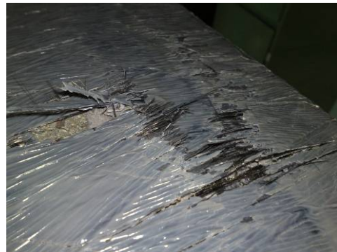
Forfecarea fibrelor din țesătură pe direcția lamelei
