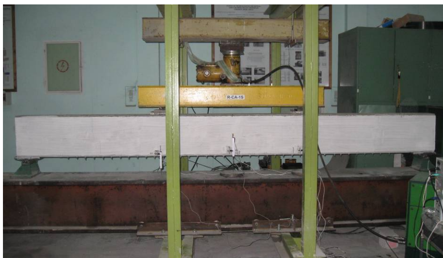
Figura 6.51. Grinda R-1S-CA pregătită pentru încercare
