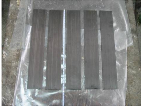
Curățarea cu diluant a lamelor de carbon și țesăturii din fibre de sticlă
