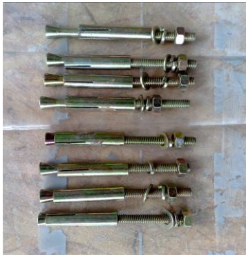
Conexpandurile de ancorare a plăcuțelor metalice
