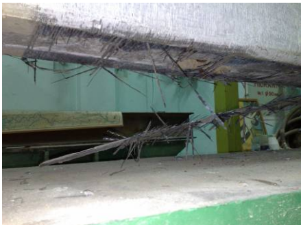
Forfecarea fibrelor din țesătură pe direcția Ruperea lamelei din flambaj la alunecare
