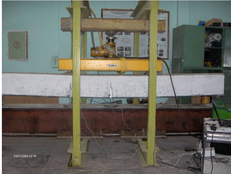
Figura 6.13. Grinda R-2W-A după încercare
