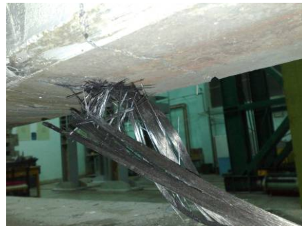
Forfecarea fibrelor din țesătură pe direcția Ruperea lamelei din flambaj la alunecare
