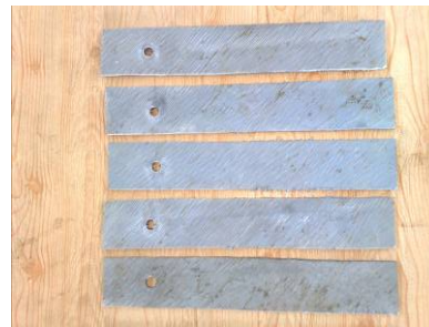
Lamele consolidate cu țesătură GFRP în 4 straturi
