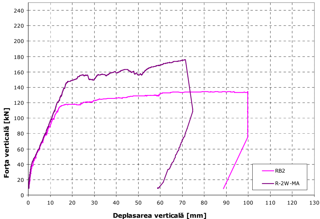
Figura 7.5. Diagramele forță-deplasare pentru grinzile R-2W-MA și RB2
