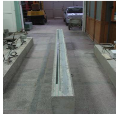
Umplerea șlițurilor cu rășină
