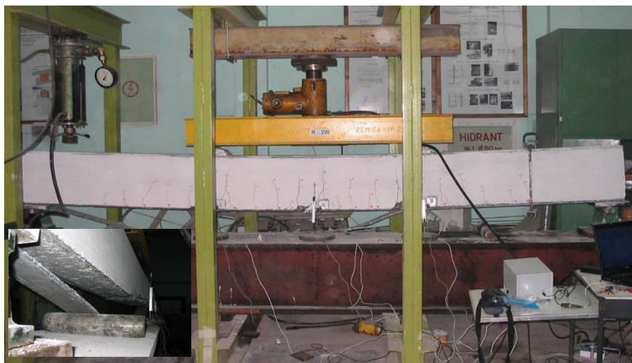
Figura 6.8. Grinda R-2W după încercare. Modul de cedare
