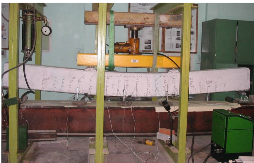
Figura 6.3. Grinda RB după încercare
