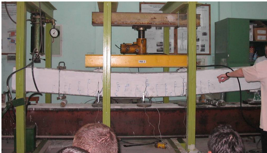
Figura 6.5. Grinda RB2 după încercare
