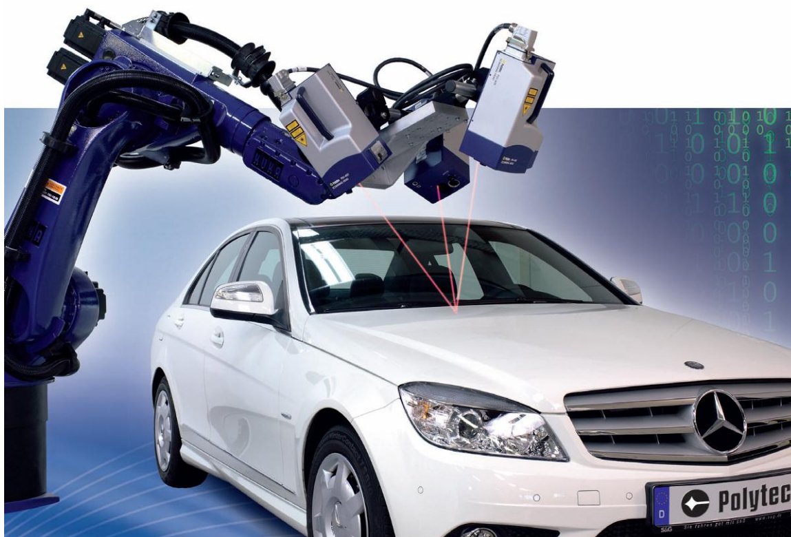
Fig.7.2. Fotografia sistemului RoboVib Structural Test Station al firmei Polytec Inc. [ROBOVIB].
