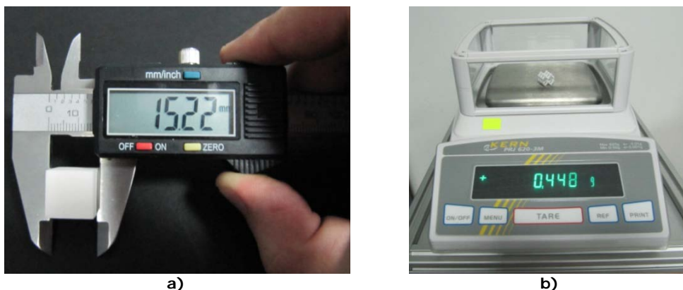
Figura 5.6 Determinarea principalelor caracteristici ale epruvetelor prototipate: a) măsurarea epruvetelor folosind șublerul digital, b) determinarea masei cu ajutorul balanței digitale.
