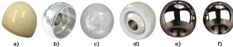
Figura 1.24 Capete: a) cap ceramic; b) cap metalic de diametru mare mărește raza de mișcare și îmbunătățește stabilitatea; c) cap cu aspectul unei mingi de golf îmbunătățește lubrifierea și reduce cantitatea particulelor de uzură; d) cap bipolar; e, f) Cap metalic de 32 mm și 28 mm. Acestea sunt fabricate prin forjare [191].
