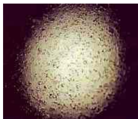
Figura 1.27 Aspectul suprafeței bilei din ceramică de zirconia retrasă din corp după câțiva ani [172].
