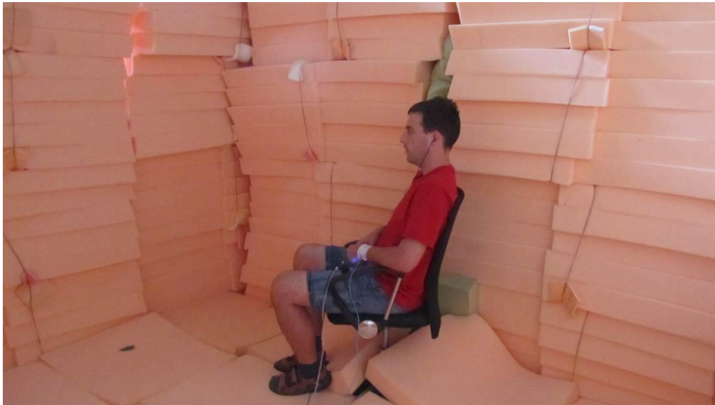
Fig. 4.7. Măsurarea funcțiilor HRTF cu subiectul așezat pe scaunul rotativ.
