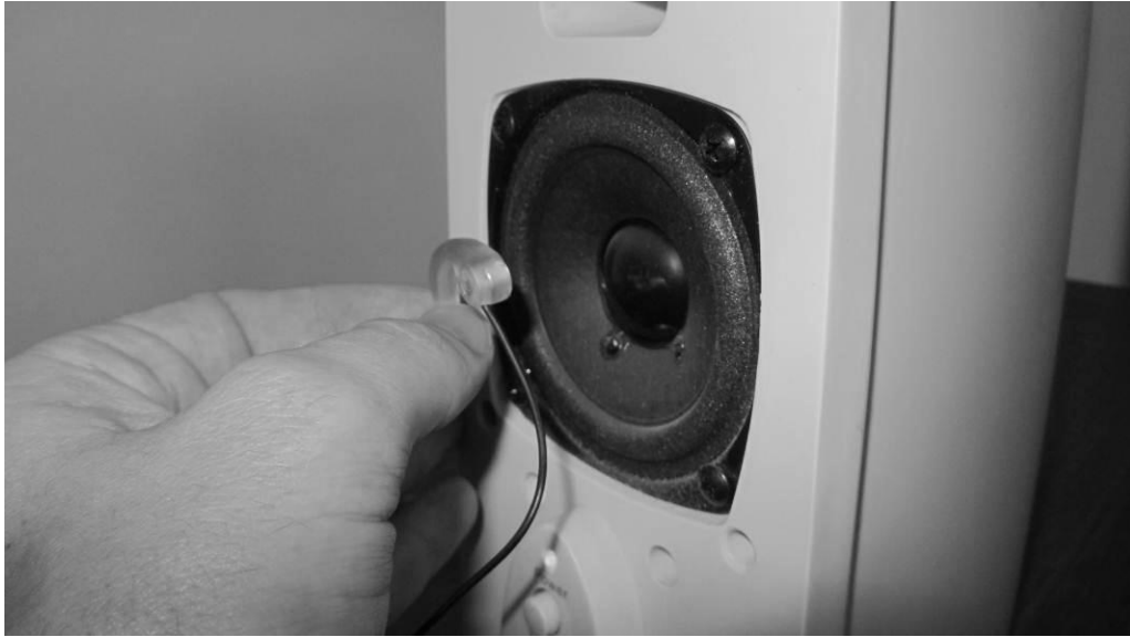
Fig. 4.17. Plasarea microfonului față de difuzor în cadrul determinării funcției de transfer.
