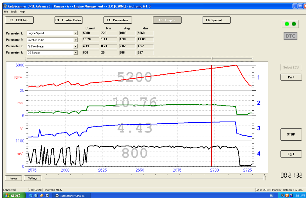
Fig. 6.4.9. Evoluția parametrilor în timpul măsurării puterii efective pentru IP50, cu 1 - turație, 2 - timpul de deschidere a injectoarelor, 3 - semnal de la debitmetrul de aer, 4 - semnal de la sonda de oxigen
