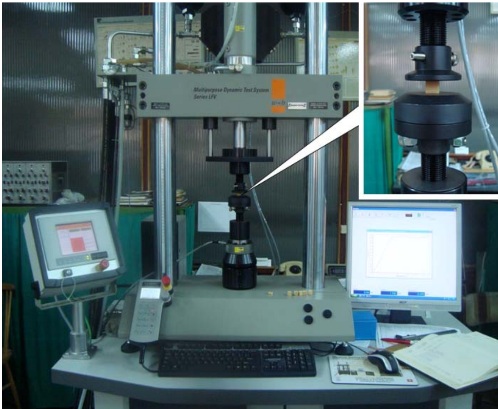
Fig. 3.6. Imagine de ansamblu a mașinii de încercat, Walter Bay de 10 kN
