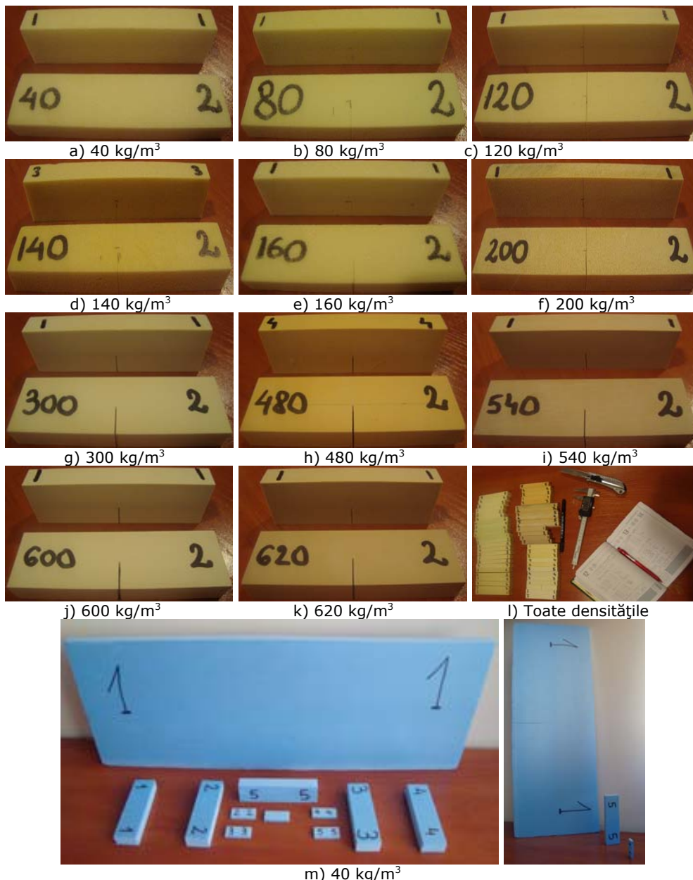
Fig. 3.43. Epruvetele utilizate în cadrul încercărilor experimentale de încovoiere în trei puncte pentru: influența densității (a-k); influența vitezei de încărcare, (d); influența planului de formare (a); efectul de scară (m).
