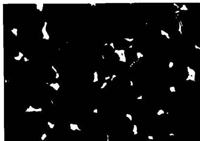
Fig.6.25. Oțel cu 0,28 % C, D = 12 mm, călit clasic/apă 20°C. Atac Nital 3 % (340:1).
