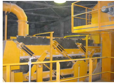
Fig. 3.4 Vedere laterală sită cu vibrație
