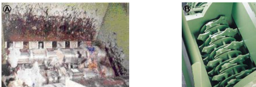
Fig. 3.1 Vederi de sus ale unei mori cu ciocane: A) cu arbore dublu; B) cu arbore simplu
