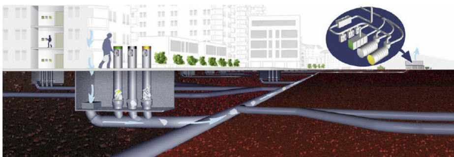
Fig. 2.27 Gestionarea fluxurilor de deșeuri în sistemul pneumatic de transport
