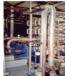
Fig. 3.45 Instalatie pentru ultra și nanofiltrarea levigatului
