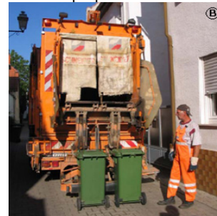
Fig. 2.23B Sisteme hidraulice de ridicare și răsturnare pentru preluarea cu pieptene sau cu fus
