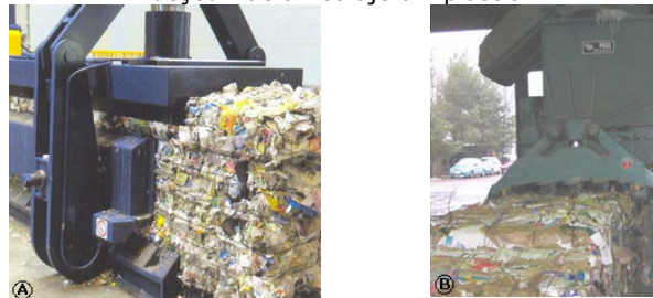
Fig. 3.13A, B Vederea unei instalații de compactare și balotare deșeurilor din hârtie și carton
