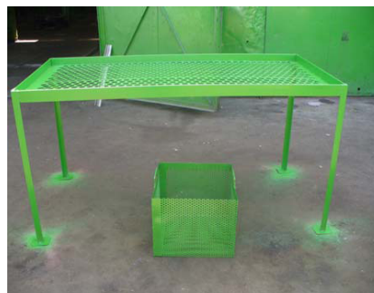
Fig. 5.25 Masa de sortare cu ciur de 40 mm diametru
