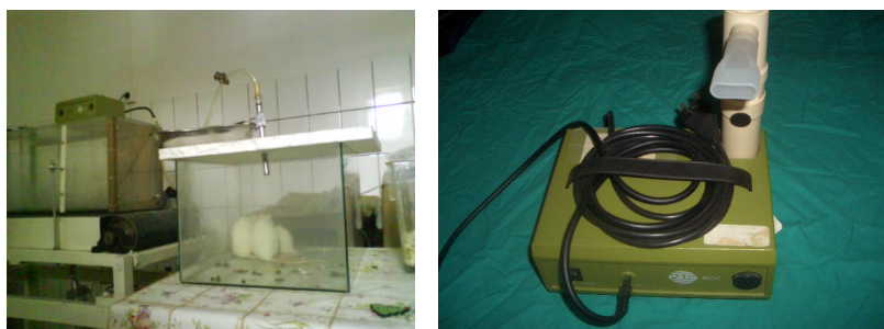
Figura 2.33. - Instalația de expunere cronică la fum de țigară și la uleiul de Juniperus . Nebulizatorul Pari Boy
