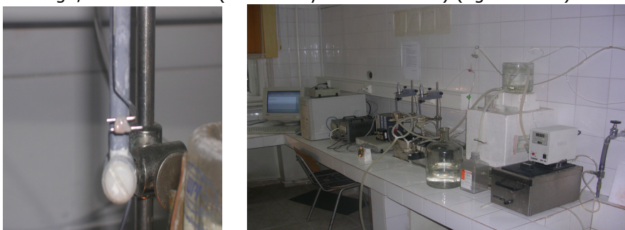
Figura 2.34. - Instalație de baie de organ BIOPAC cu unitate de achiziție MP 100 și traductor de forță izometric FORT 10
