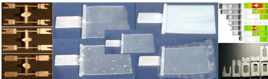
Fig.3.3. Defecte apărute la piese obținute prin microinjectare[Sammoura, 2006][NRC, 2007]
