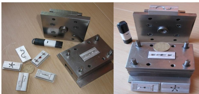
Fig.7.25 Matrița de microinjectare și pastilele amovibile
