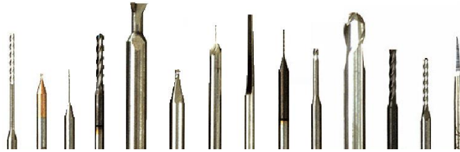
Fig. 3.12. Tipuri de scule miniaturale utilizate in microinjectare.
