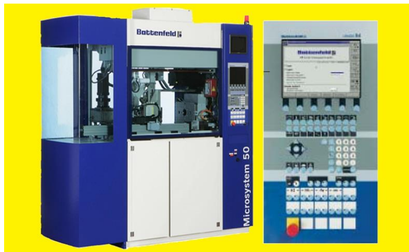
Fig. 3.9. Mașina de microinjectat Microsystem 50.[BMB, 2003], [Fuchs, 2007]
