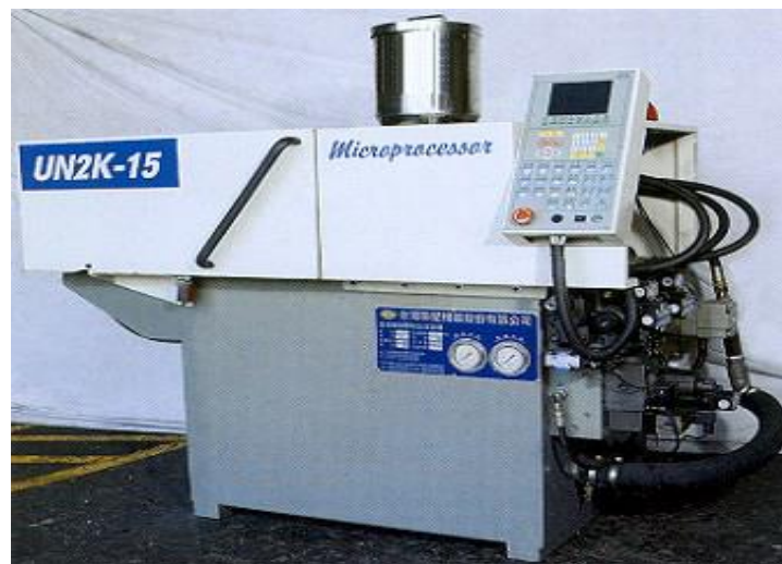
Fig. 3.11. Mașina de microinjectat UN2K-15 [Hwee, 2007]
