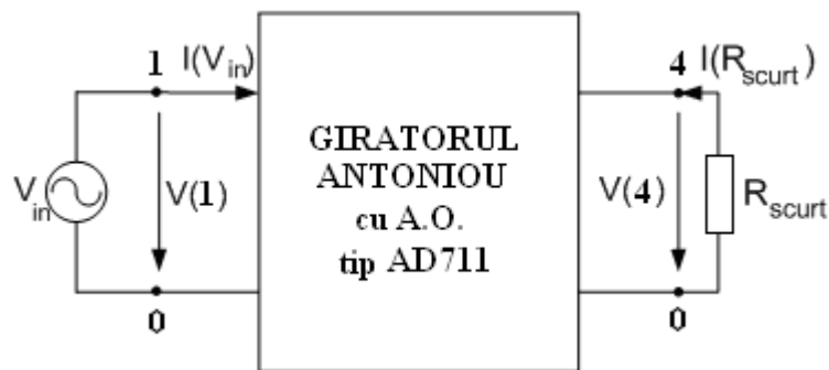
Fig.6.3 Giratorul Antoniou alimentat pe la poarta 1 cu ieșirea practic în scurtcircuit
