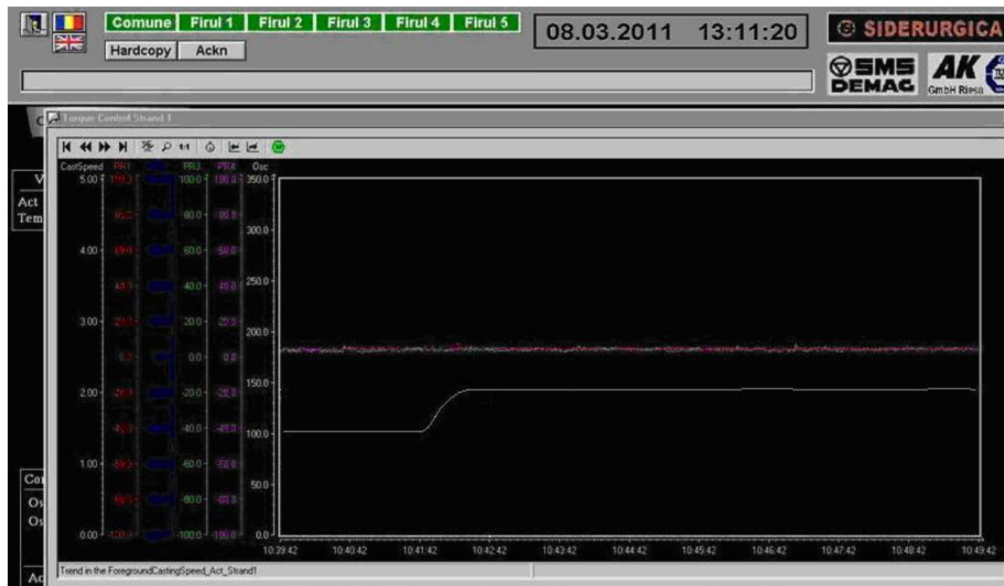
Fig. 6.37 Variația vitezei rolei pasive cu SFA în funcțiune
