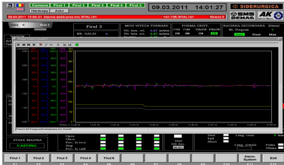
Fig. 6.31 Evoluția vitezei de turnare in momentul apariției unei fisuri
