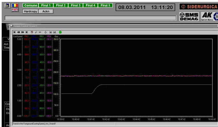
Fig. 6.36 Variația vitezei rolei active cu SFA în funcțiune
