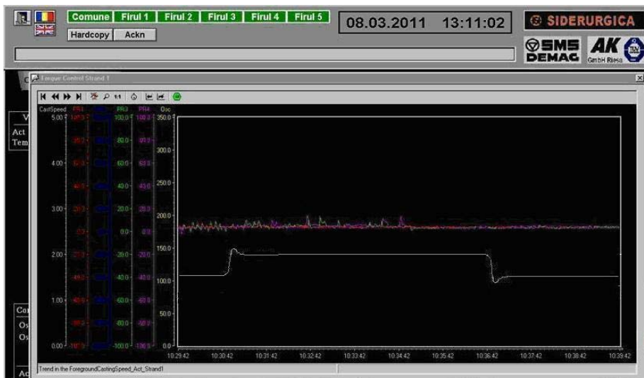
Fig. 6.34 Variația vitezei rolei active fără acțiunea SFA
