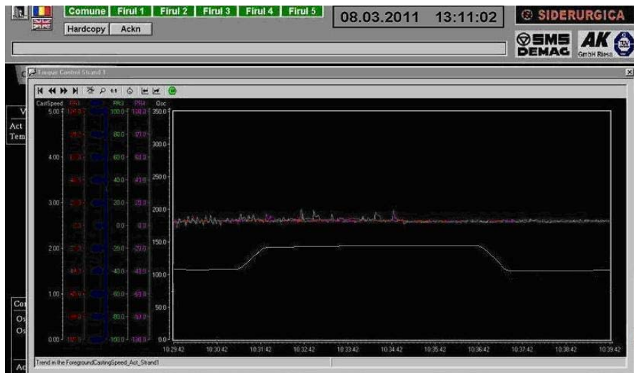
Fig. 6.35 Variația vitezei rolei pasive fără acțiunea SFA
