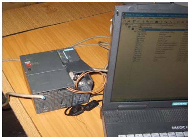
Fig. 6.28 Încărcarea în PLC a configurației hardware și software utilizând o consolă de programare pe MPI
