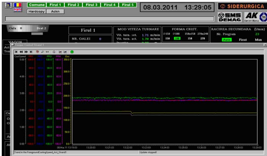
Fig. 6.33 Evoluția vitezei de turnare în momentul riscului de apariția a unei fisuri
