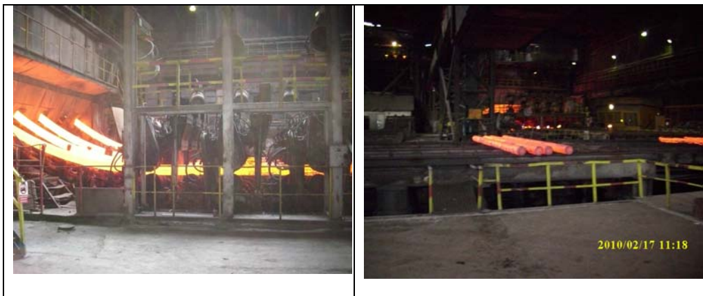
Fig. 6.6 Instalația de turnare continuă de la A.M.-HD.
