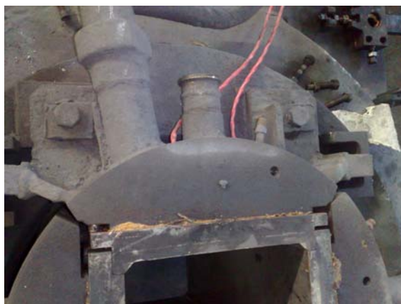
Fig.4.23 Cristalizadorul din cadrul instalației de turnare continuă pe care s-au realizat determinările experimentale
