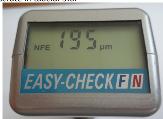
Figura 3.32 Măsurarea grosimii straturilor cu aparatul Easy-Check
