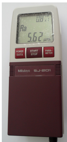
Figura 3.33 Măsurarea rugozității straturilor depuse cu aparatul Mitutoyo
