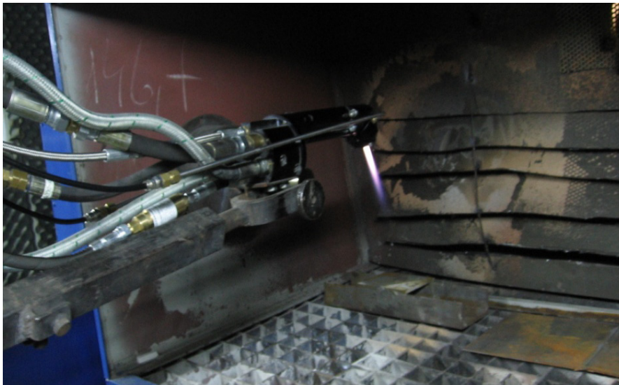
Figura 4.11 Imagine din timpul procesului de pulverizare termică cu metoda HVOF
