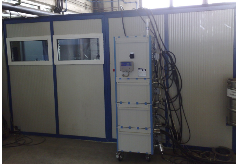
Figura 4.10 Incinta izolată fonic pentru pulverizare HVOF
