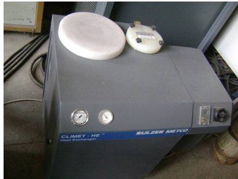
Figura 3.15 Instalație de răcire a circuitului primar
