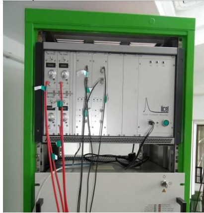
Figura 5.5. Realizarea conexiunilor pentru canalele de achiziție
