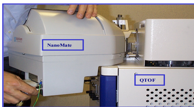
Fig.5.1.3. Cuplajul dintre robotul NanoMate, echipat cu chip ESI, cu spectrometrul de masă QTOF MS
