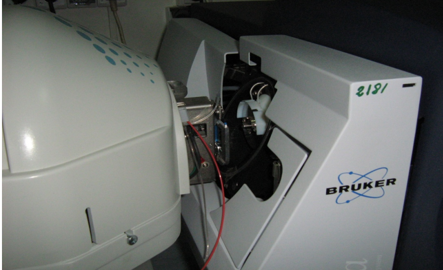
Fig. 6.1.1 Cuplajul chip-spectrometru de masă a) vedere a întregului ansamblu; b) contactul robot-spectrometru de masă cu chip-ul de siliciu conectat; c) infuzia probei prin chip în spectrometrul de masă
