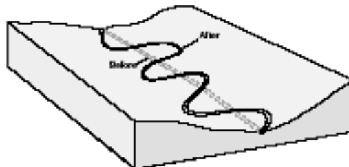
Fig. 3.19: Prezentare schematică a refacerii unui curs recalibrat
