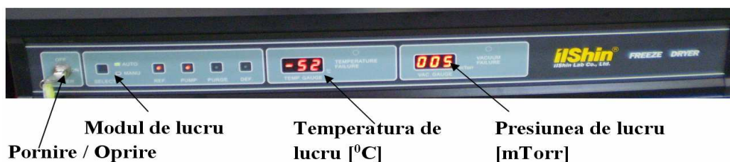
Figura 3.3.4. - Panoul de control al liofilizatorului II Shin tip. Floor Model Freeze Dryer FD 5512
