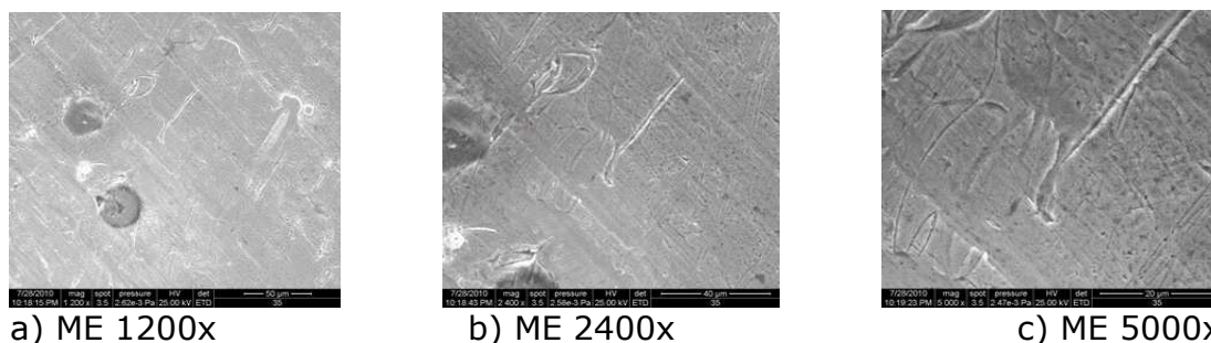
Figura 4.3.20. – Reprezentări microscopice (ME) ale tablei de alamă în contact cu lămâia în timpul liofilizării
