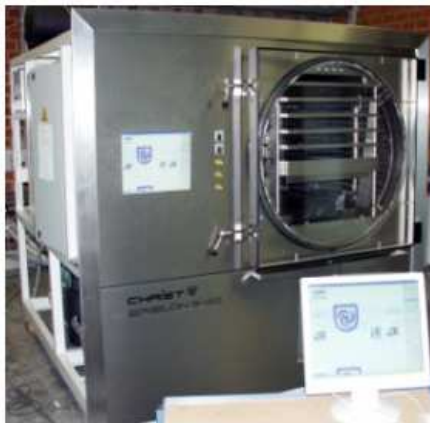
Figura 2.3.2. – Instalație de liofilizare cu o singură cameră de uscare tip Epsilon 2 - 90, [***, www k]
