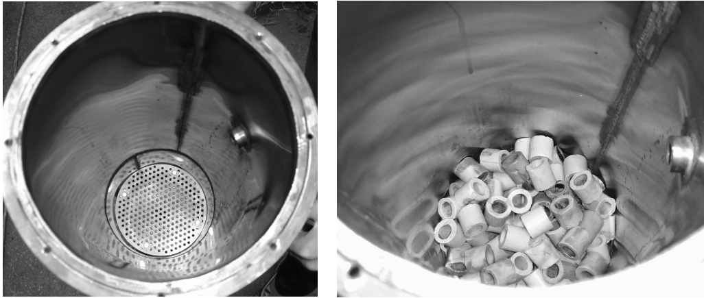
Figura 5.6. Coloana de absorbție (în stânga) taler perforat și (în dreapta) umplută din inele ceramice Raschig 26×26×5
