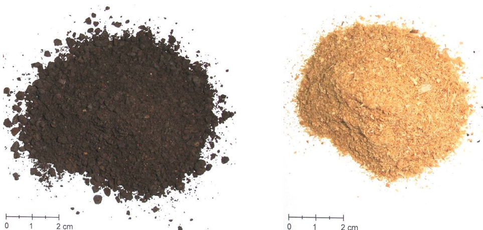
Figura 6.1. Mostre de combustibil după măcinare, lignit Motru (în stânga) și rumeguș de fag (în dreapta)
