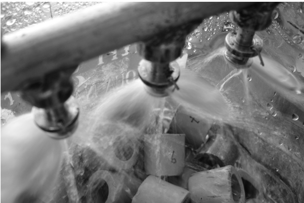
Figura 5.5. Stropirea și distribuția lichidului peste un strat de umplutură din inele Raschig ceramice (în timpul încercărilor)
