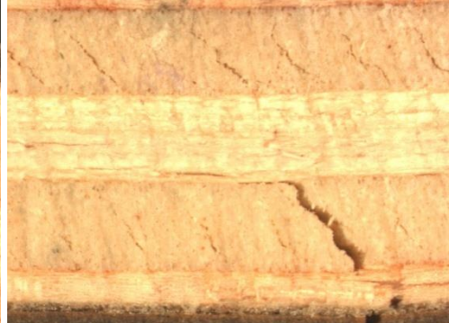
Fig. 4.53 – Ruperea probei la temperatura de -5 °C
