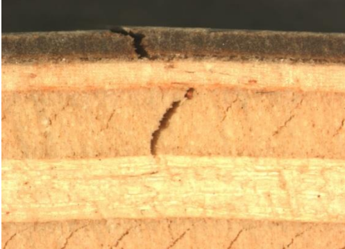
Fig. 4.52 – Ruperea probei la temperatura de -5 °C
