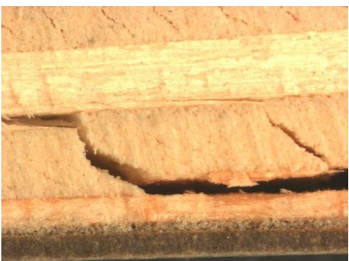
Fig. 4.50 – Ruperea plăcii de lemn cu grosime 2 mm, orientare 0°
