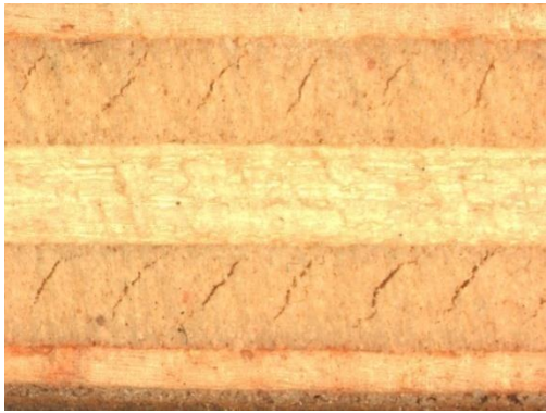
Fig. 4.45 – Apariția primelor fisuri la solicitarea de încovoiere
