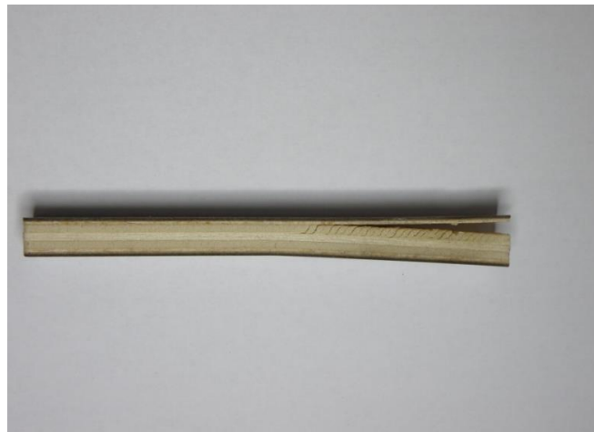
Fig. 4.49 – Desprinderea stratului de lemn cu grosime 1 mm, orientare 90°, de stratul de lemn următor cu grosime 2 mm, orientare 0°
