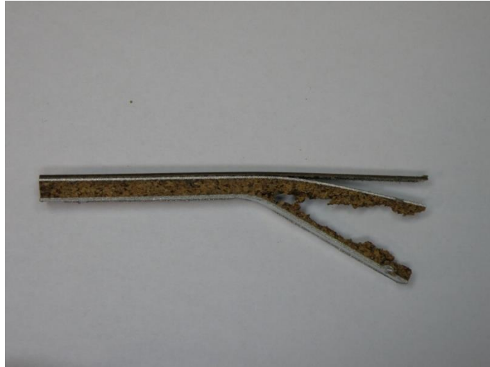
Fig. 4.110 – Ruperea materialului prin încovoiere la temperatură de -5 °C
