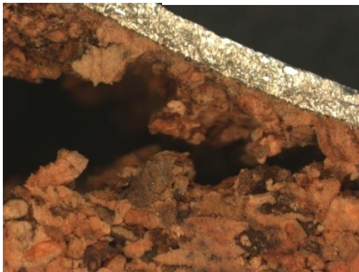
Fig. 4.111 – Ruperea materialului prin încovoiere la temperatură de -5 °C – detaliu ruperea plutei
