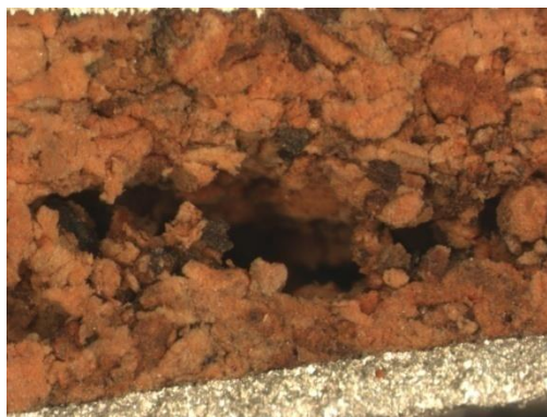
Fig. 4.109 – Ruperea materialului prin încovoiere la temperatură ambiantă – detaliu ruperea plutei
