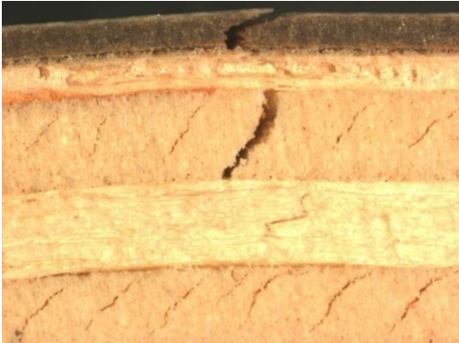
Fig. 4.47 – Declanșarea ruperii în placa de melamină
