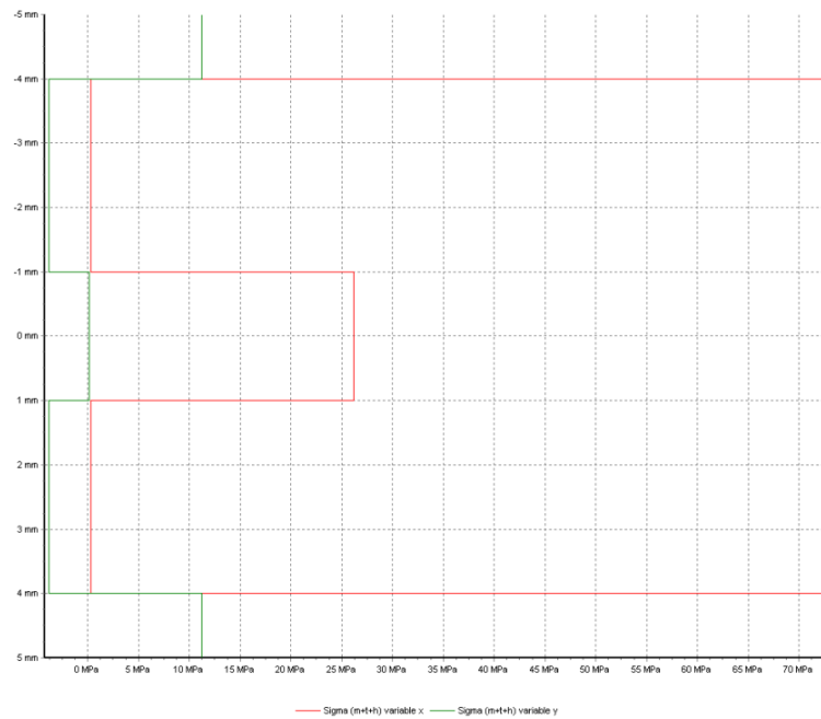
Fig. 2.25 - Distribuția tensiunilor normale \sigma_x și \sigma_y pentru materialul 2
