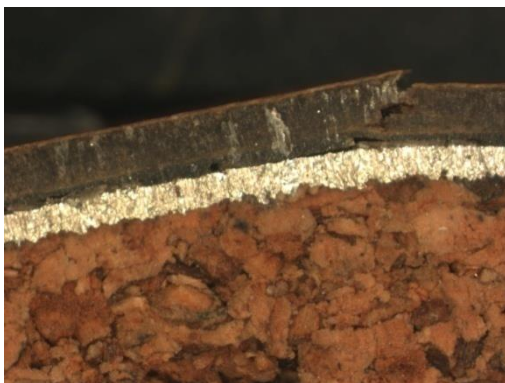
Fig. 4.108 – Ruperea materialului prin încovoiere la temperatură ambiantă
