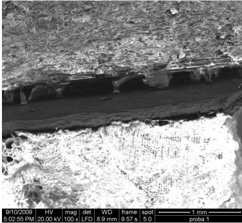
Fig. 4.102 – Ruperea ductilă a feței de aluminiu (x100)
