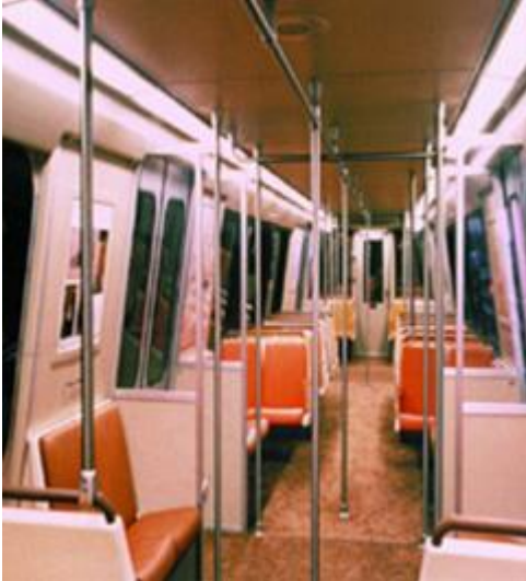
Fig. 1.3 – Caroseria unui vagon de metrou cu plafon din material sandwich compus din miez de plută și fețe de aluminiu
