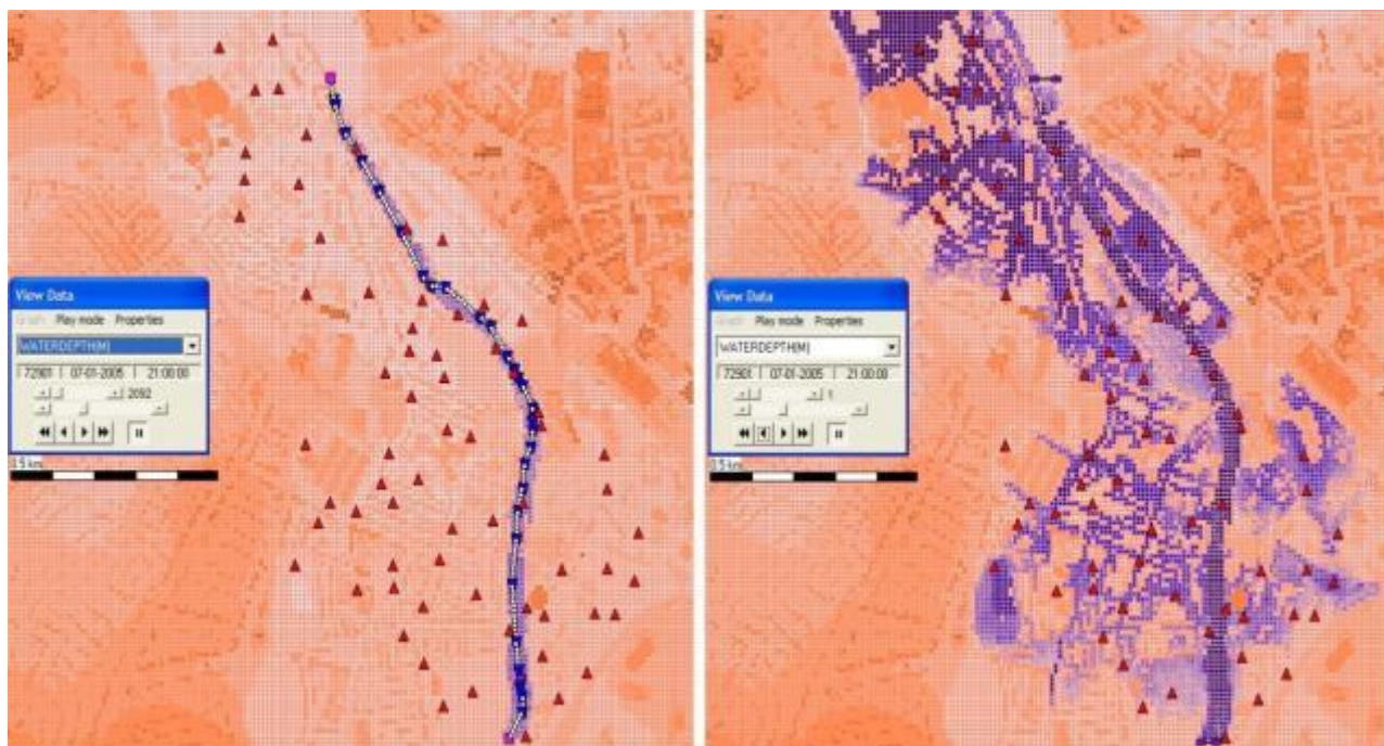
Fig. 6-49 Harta de inundație după 21h de la începerea fenomenului, modelată în SOBEK 1D2D (stânga) și SOBEK 2D (dreapta)
