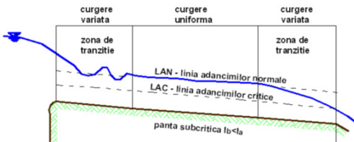
Fig. 2-7 Dezvoltarea curgerii uniforme I_b < I_a
