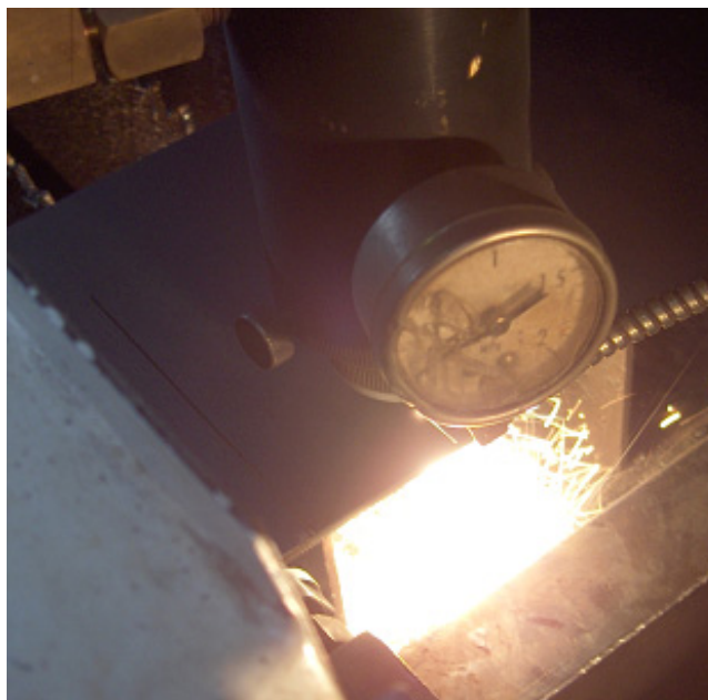
Figura 2.4. – Sistemul tehnologic 1500 W, capul de lucru
