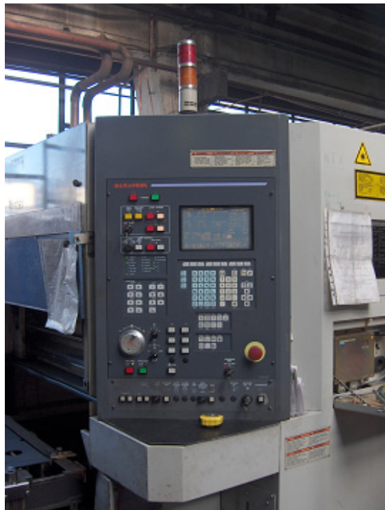
Figura 2.3. – Sistemul tehnologic Mazak 1500 W, pupitru de comandă
