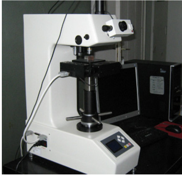
Figura 2.10. – Sistemul tehnic pentru examinarea metalografică și determinarea durității
