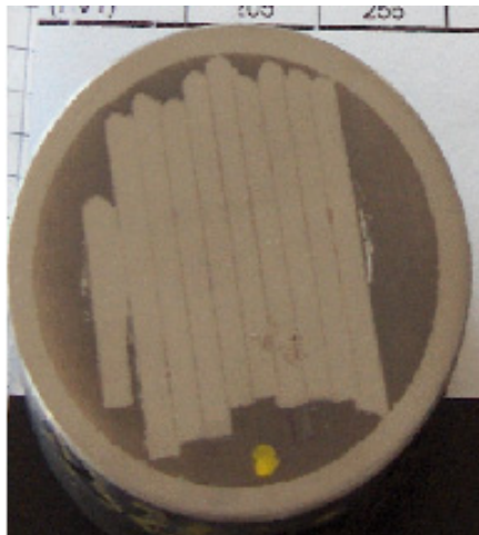
Figura 5.20. – Pregătirea probelor pentru analiza metalografică
