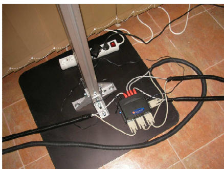
Fig. 4.5. Head controller pentru transmiterea informației spre portul serial al PC
