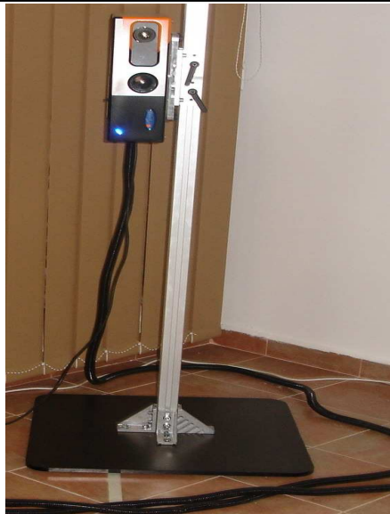
Fig. 4.4. Montarea Camerei 3D Mega Capturor II pe elementul de susținere
