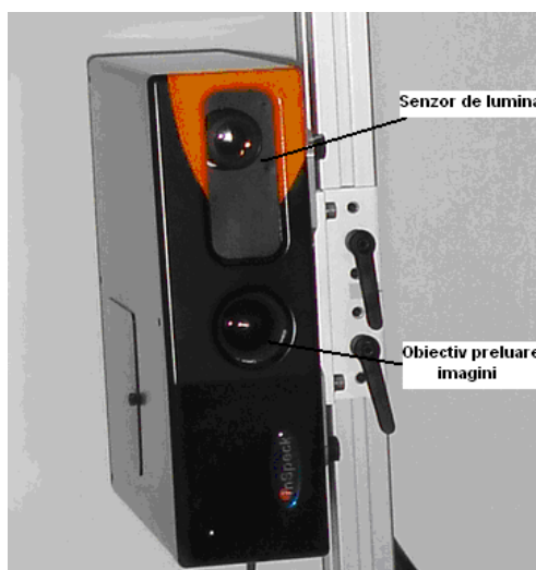
Fig.4.3. Camera digitală InSpeck 3D Mega Capturor II
