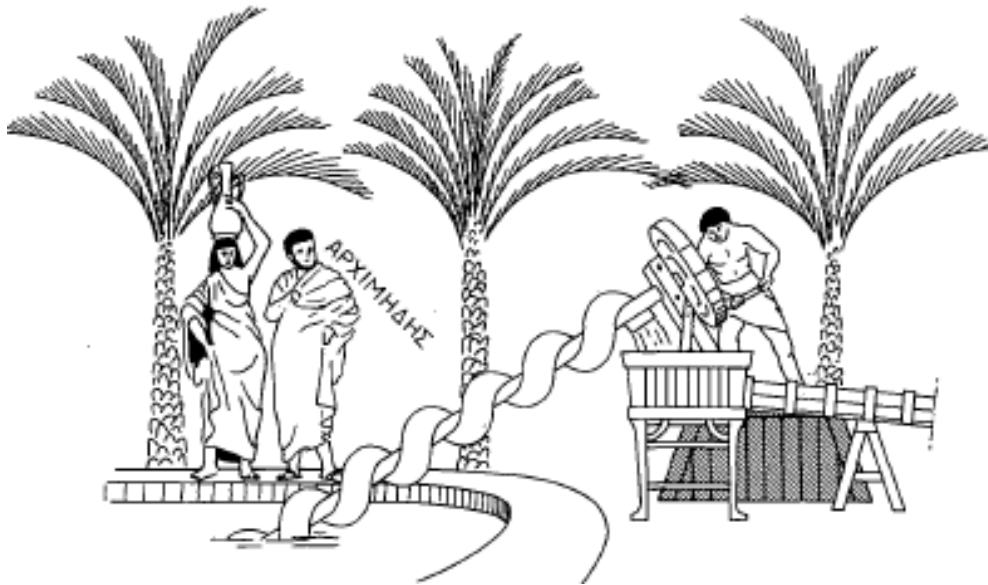
Fig. 2.1 Desecarea cu ajutorul șurubului lui Arhimede [42]
