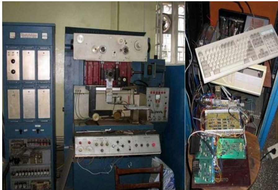
Figura 2.47 – Mașina de prelucrat prin eroziune electrică cu fir de tipul Elerofil, aflată în dotarea laboratorului de eroziune electrică
