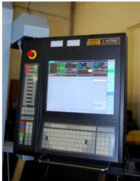
Figura 2.48. CNC LN1W folosit la comanda mașinii prin eroziune electrică AQ300L
