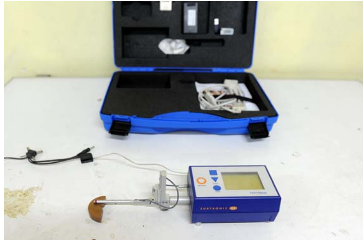
Fig. 4.1. Rugozimetrul Surtronic 25 folosit la măsurarea rugozității suprafețelor prelucrate
