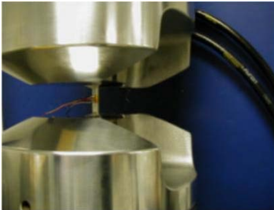
Figura 4.4 Echipamentul folosit pentru măsurarea alungirilor.
