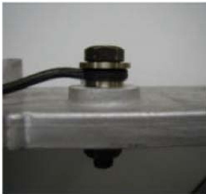
Figura 4.6 Montarea senzorului folosit pentru măsurarea strângerii remanente.
