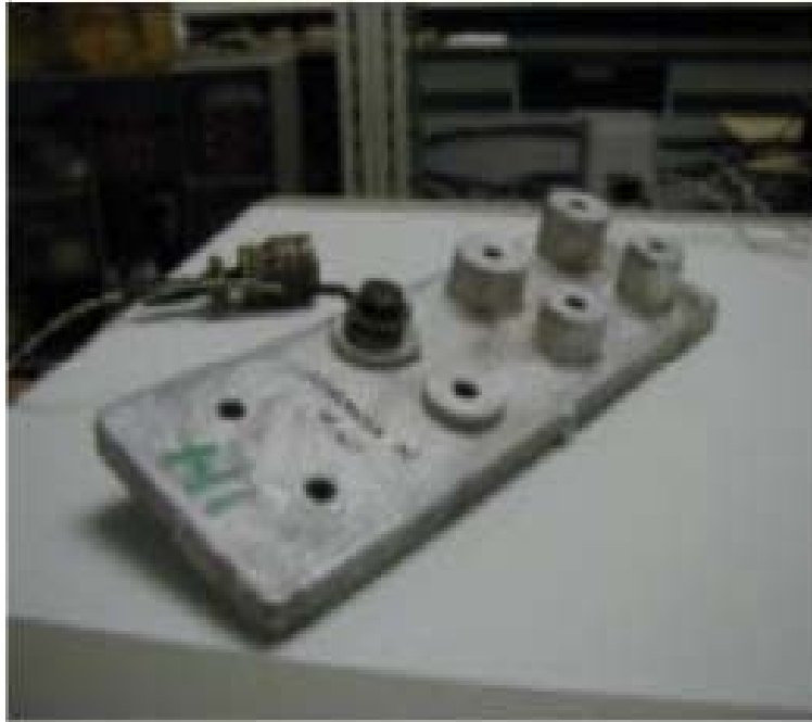
Figura 4.5 Epruveta și senzorul folosite pentru măsurarea strângerii remanente.
