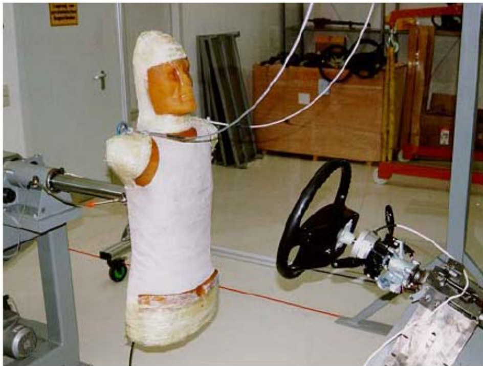
Figura 6.16 Banc de probă pentru încercarea la impact cu volanul
