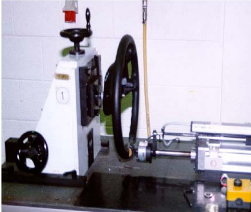
Figura 6.13 Banc de probă pentru încercarea ciclică la încovoiere
