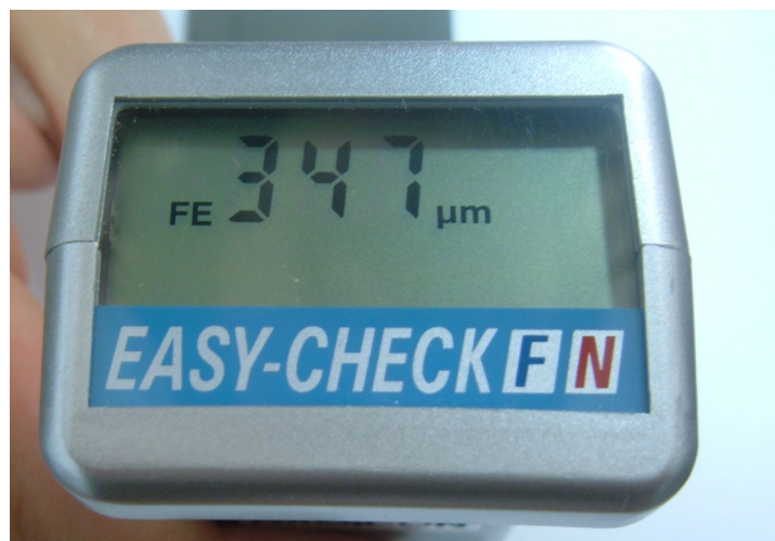
Fig. 3.19 Măsurarea grosimii straturilor cu aparatul Easy-Check
