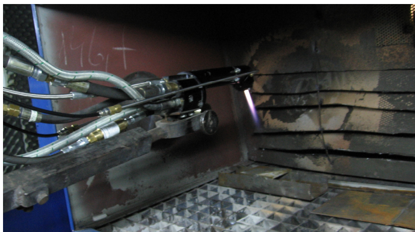
Fig. 3.18 Aspect din timpul operației de pulverizare termică cu metoda HVOF
