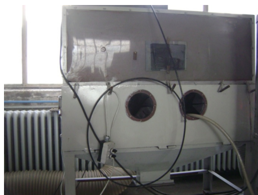
Fig. 3.16 Instalația de sablare
