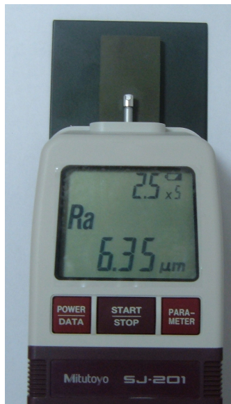
Fig. 3.20 Măsurarea rugozității straturilor depuse cu aparatul Mitutoyo
