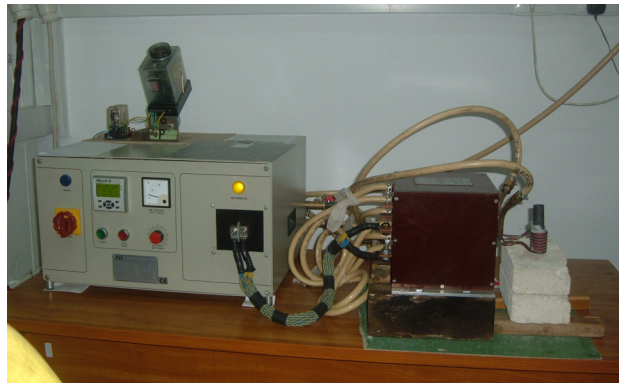
Fig. 4.11 Instalația utilizată pentru sinterizarea pulberilor WC-Co
