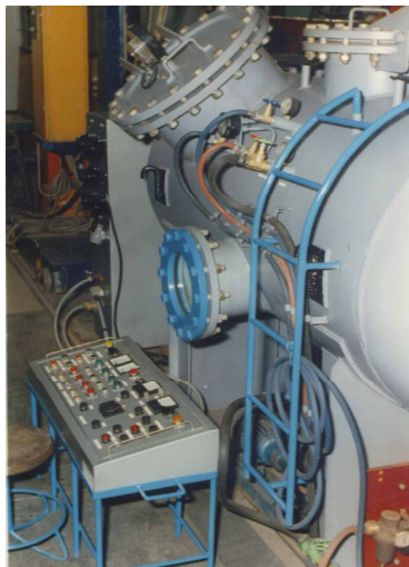
Figura 5.27 Simulator de sudare subacvatică și hiperbarică
