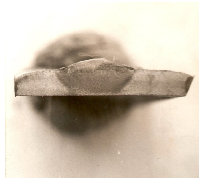
Figura 5.25. Macrostructura depunerii P5
