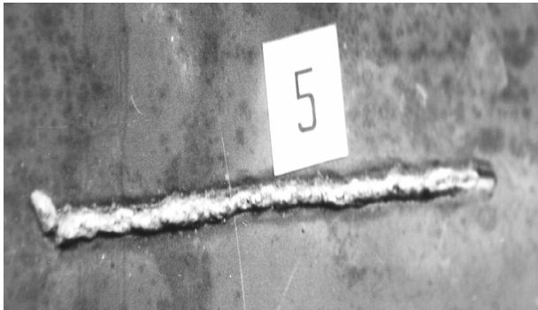
Figura 5.24. Proba P5 sudată sub apă:
