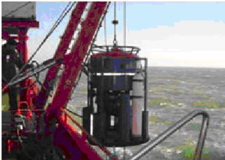
Figura 6. Turelă de scufundare folosită în sistemul turelă-cheson [21].
