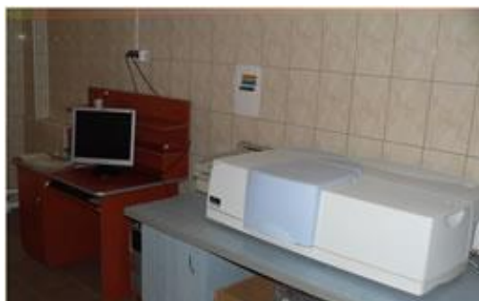
Figura 4.4. Imagine spectrofotometru UV-VIS-NIR Lambda 950
