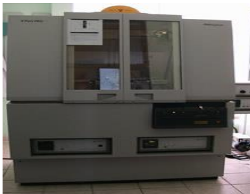
Figura 4.3. Imaginea unui difractometru de raze X de tipul X'Pert PRO MPD
