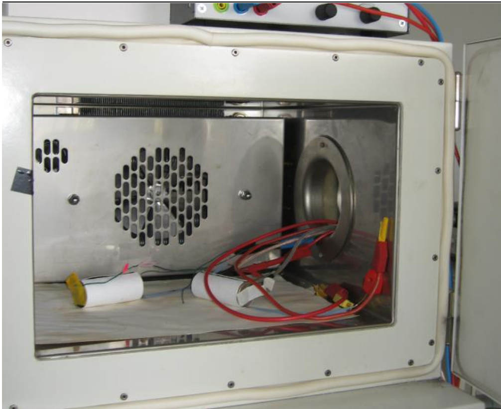
Fig. 5.7 Celule Li-ion cu folii încălzitoare introduse în camera termică Votsch VT 4002
