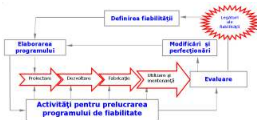
Fig. 4.39. Legătura dintre fiabilitate și stadiile realizării produselor
