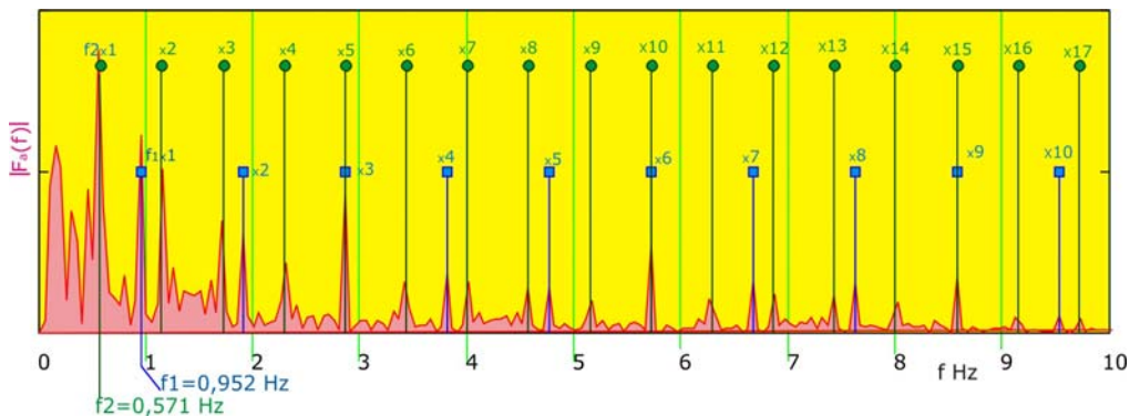
Fig.2.9. Spectrograma anvelopei semnalului u(t) , cu ilustrarea liniilor de periodicitate corespunzătoare celor două perturbații având frecvențele f_1 = 0.952 \text{ Hz} și f_2 = 0.571 \text{ Hz} .
