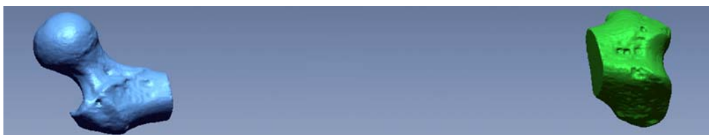
Fig. 7.2.11.b. Mesh-ul rafinat al învelișului interior al femurului în zonele epifizelor (vederea b).
