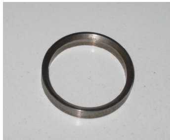
Fig 5.8 Inel de supapă sinterizat 9III Rețeta cu 9% Cu Sinterizat la 1.250°C Tratat termic
