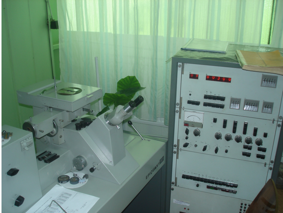
Fia 5.2 Microscopul metalografic intearator de structură EPIQUANT și calculatorul
