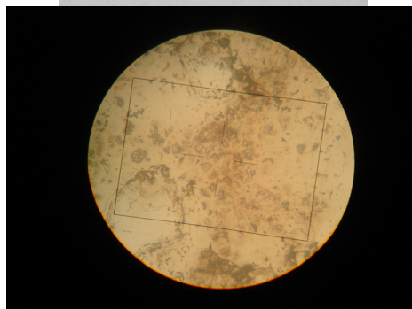
Fig 5.9 Inel de supapă sinterizat 12I Rețeta cu 12% Cu Sinterizat la 1.150°C Netratat termic
