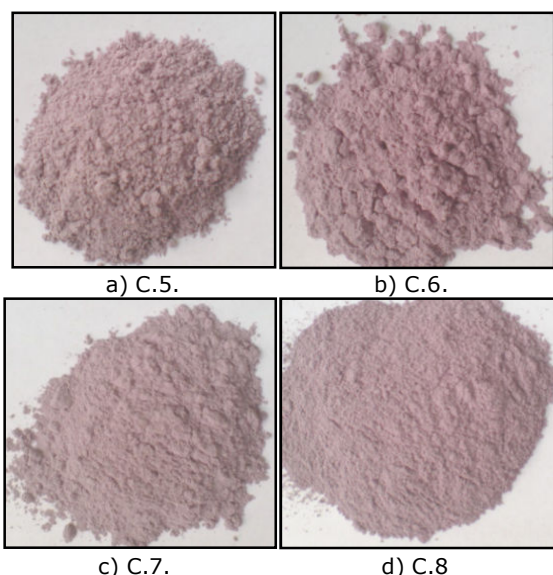
Fig. 10. Pigmenți roz cu structură de corindon ( Al_{1,80}Cr_{0,20}O_3 ) tratați termic la 1100 °C.
