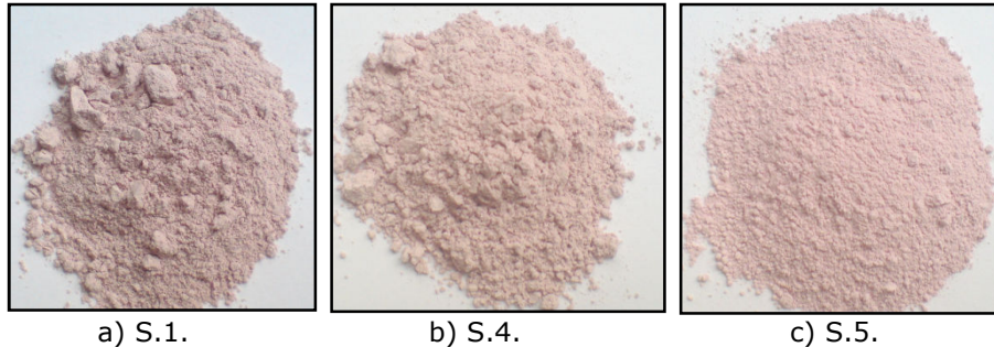
Fig. 23. Pigmentul roz ( \text{ZnAl}_{1.90}\text{Cr}_{0.10}\text{O}_4 ) obținut prin metoda clasică ((a) fără mineralizator; (b) 2% \text{CaF}_2 ; (c) 2% \text{Li}_2\text{O} ).
