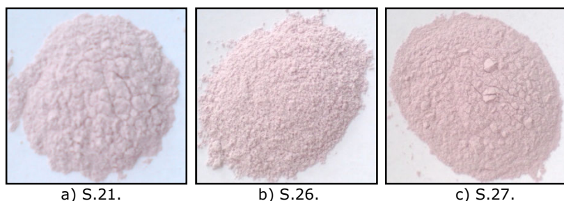
Fig. 43. Pigmenți roz cu stoechiometria \text{MgAl}_{1,90}\text{Cr}_{0,10}\text{O}_4 tratați termic la 1200 °C și obținuți prin metoda clasică (a) și metoda precursorilor organici (b) și (c).
