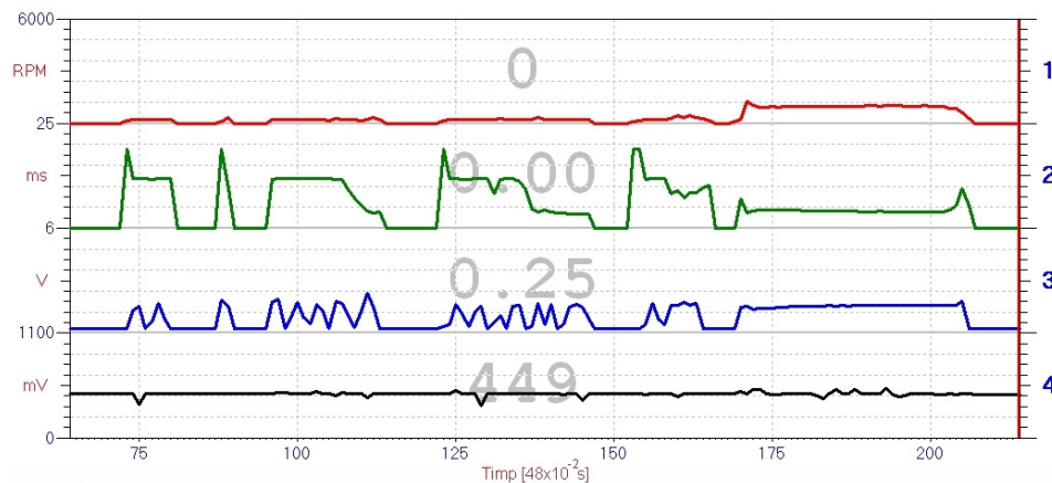
Fig. 5.26. Evoluția parametrilor pentru pornire la rece cu IB70, cu 1 – turație, 2 – timpul de deschidere a injectoarelor, 3 – semnal de la debitmetrul de aer, 4 – semnal de la sonda de oxigen
