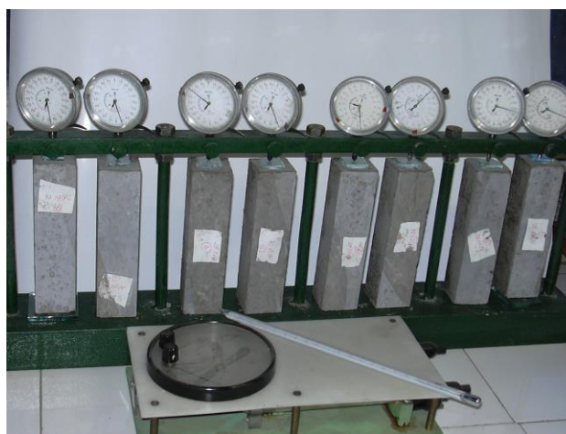
Fig. 4.5. Măsurarea contracției în mediul ambiant la mortare
