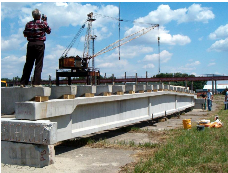
Fig. 5.15. Grinzile din beton autocompactant încărcate cu grinzile secundare
