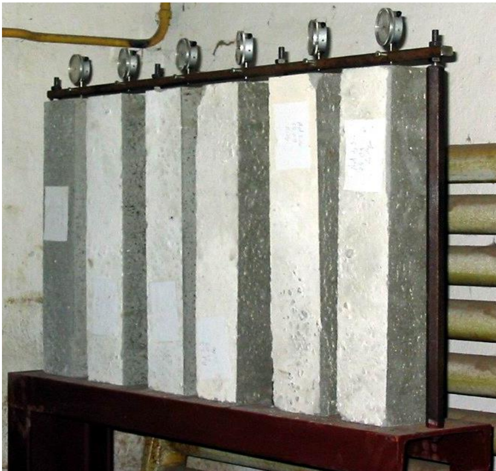
Fig. 4.8. Măsurarea contrației la prismele de beton
