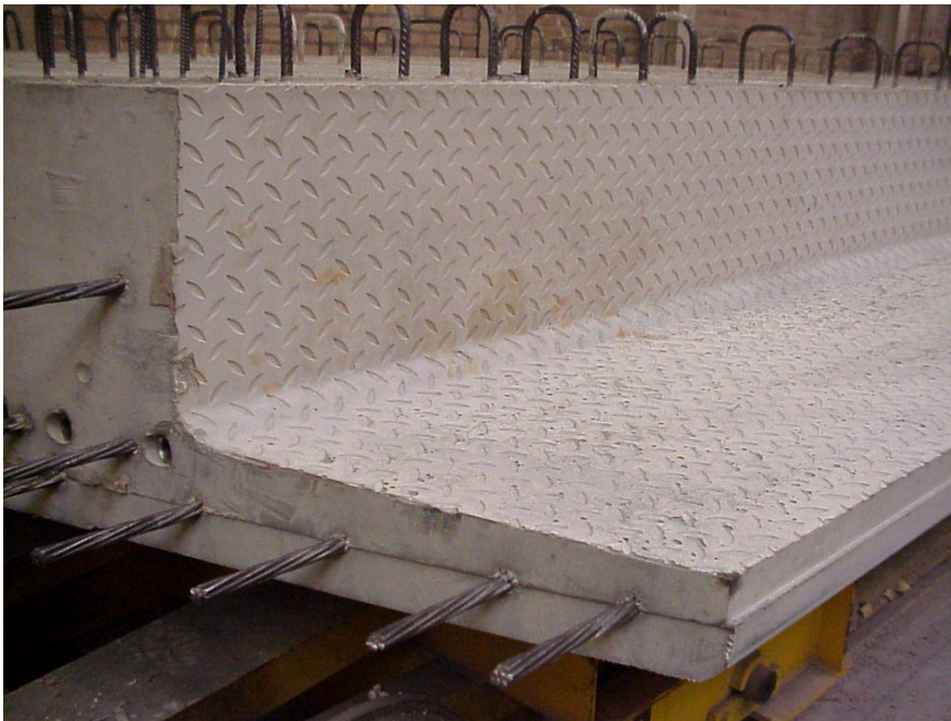
Fig. 5.9. Detaliu suprafață a unui element prefabricat din beton autocompactant
