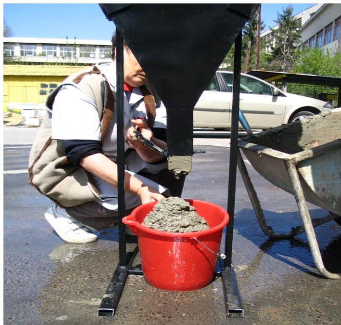
Fig. 5.41a. Testul Pâlniei V
