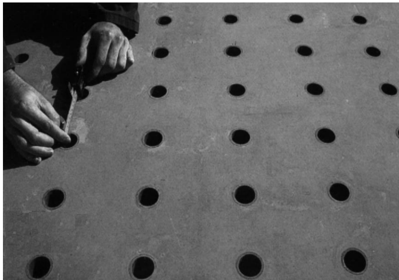
Fig. 3.6. Dală-filtru din BPR pentru epurarea apelor uzate
