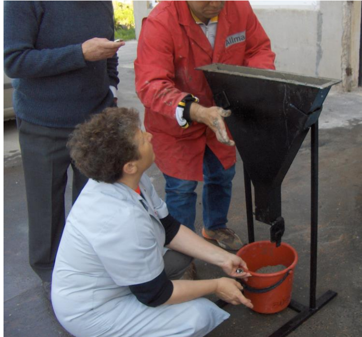
Fig. 5.41b. Testul Pâlniei V
