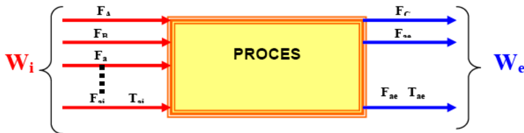
Fig. 2.1. Reprezentarea schematică a unui proces, cu evidențierea debitelor masice și energetice de intrare și de ieșire.
